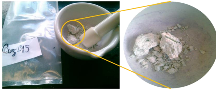
Figura 2.11. Muestra Cuz-15 en mortero de porcelana. Laboratorio de DRX, Instituto de Geología, UNAM.
