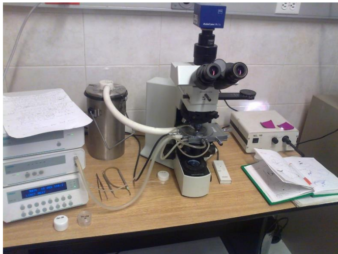
Figura 2.14. Microscopio petrográfico Olympus con platina térmica Linkam THMSG 600 para el análisis microtermométricos de inclusiones fluidas. Laboratorio de Yacimientos del Centro de
