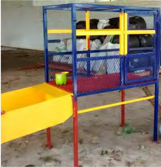
Se usaron jaulas metabólicas diseñadas y construidas especialmente para este experimento, las medidas fueron: 1.20 m de largo, 60 cm de ancho, altura de 70 cm del piso, con comedero abatible y dos puertas; una posterior y otra al lado izquierdo para facilitar el manejo y la toma de muestras, el piso fue de rejilla que permitía el paso de las heces para su recolección total. Debajo
