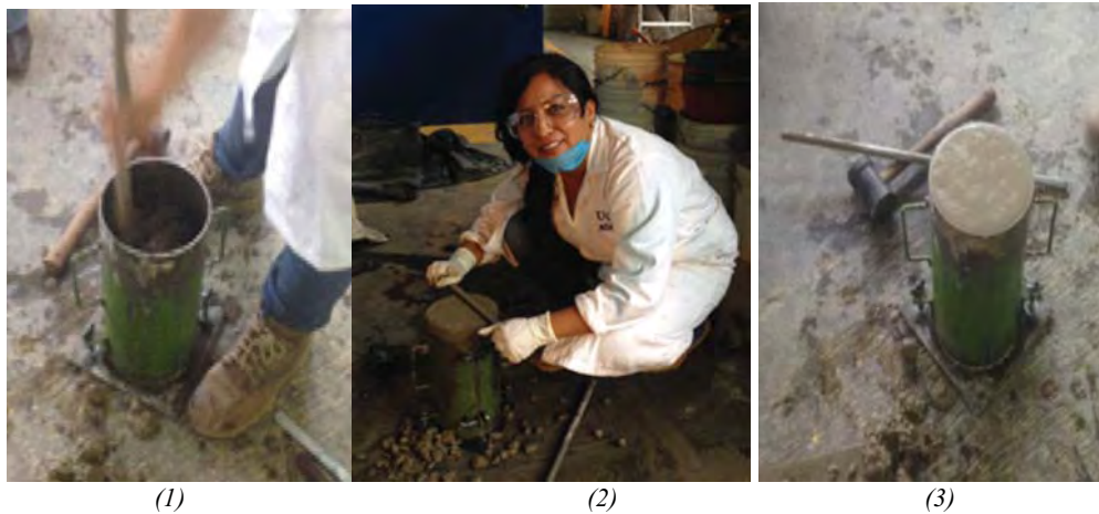
Figura 3.12 Elaboración de especímenes 1. Llenado y compactado de mezcla, 2. Enrase de molde, 3. Cilindro terminado.
