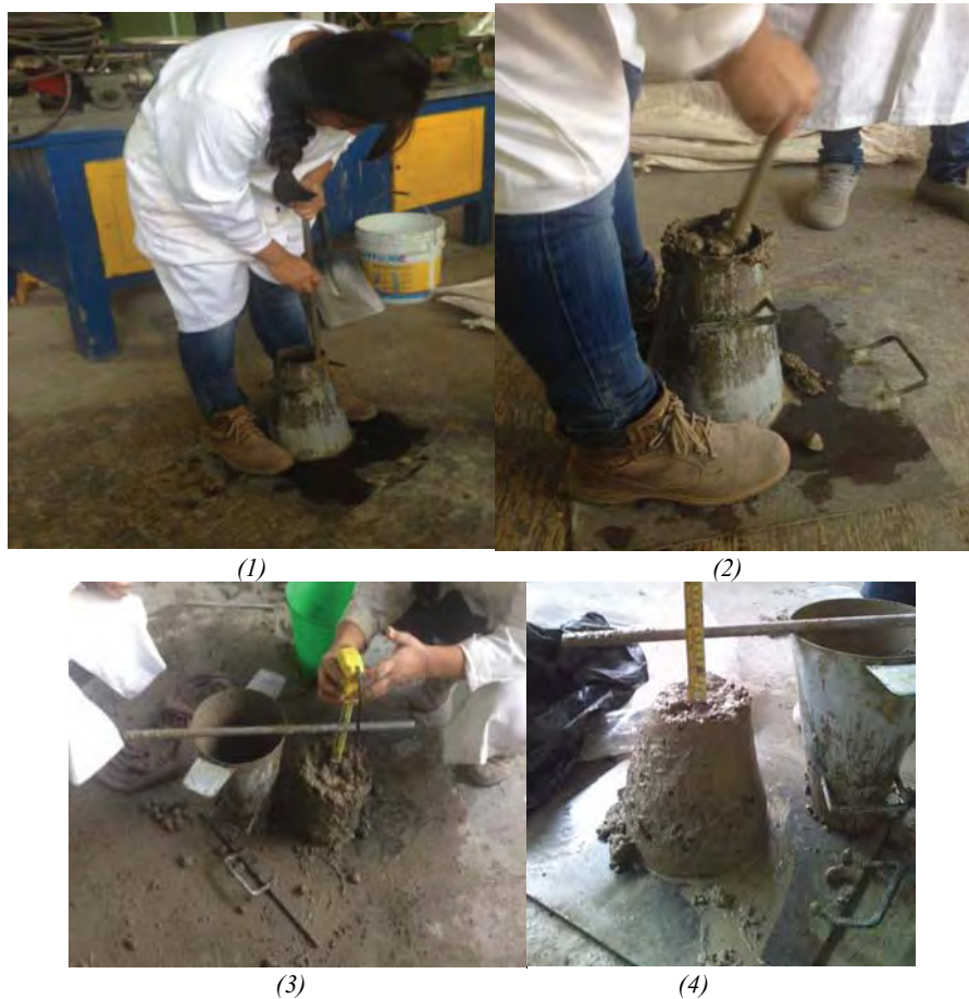
Figura 3.9 Prueba de revenimiento
