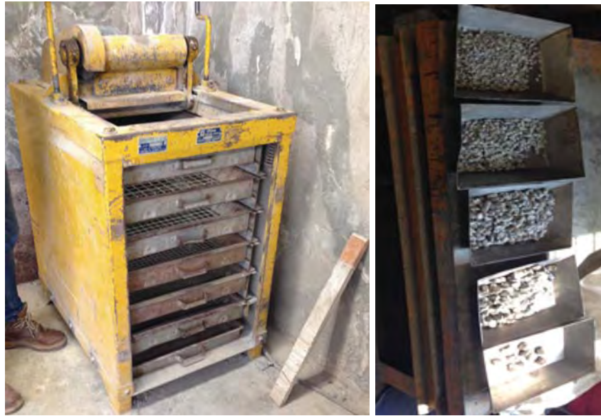
Figura 3.3 Criba mecanizada para AG
