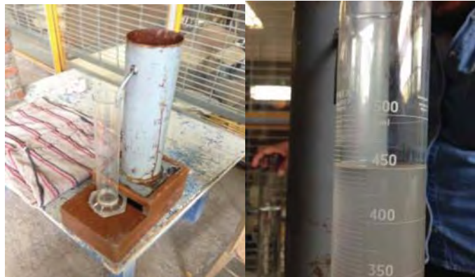
Figura 3.5 Obtención de densidad para AG
