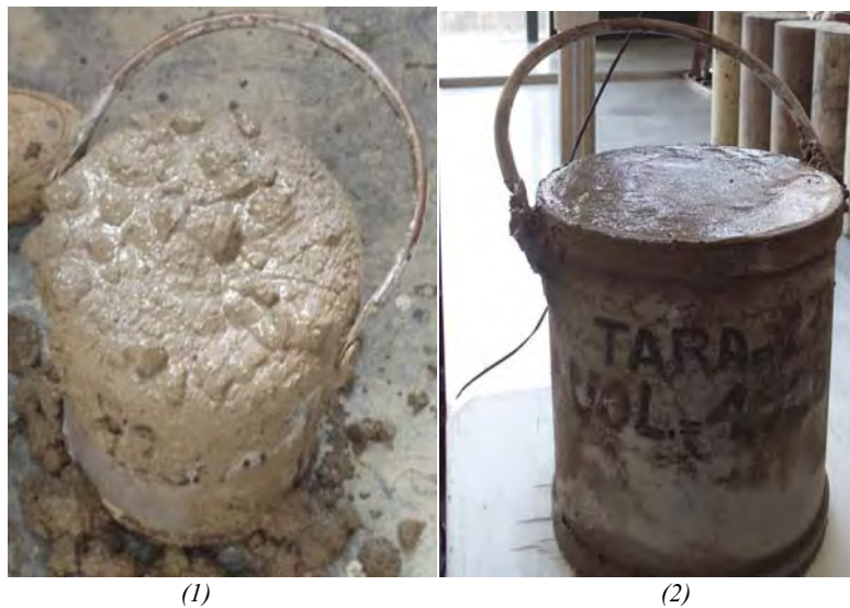
Figura 3.10 Determinación de peso volumétrico de concreto fresco 1. Llenado de recipiente, 2. Mezcla compactada para determinación de su masa.
