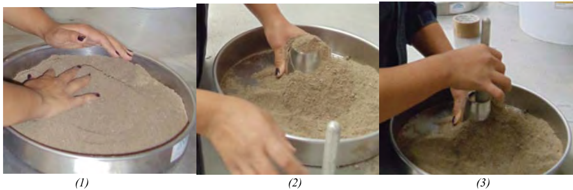
Figura 3.6 Determinación de estado sss para AF 1. Secado de material, 2. Llenado de cono truncado, 3. Compactación de arena.
