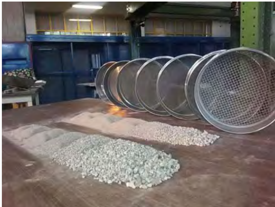
Figura 3.4 Criba manual para AF
