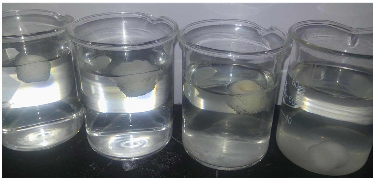
Figura 176. Seguimiento de la flotación e hinchamiento de las matrices de HPMC 100000 40/25, alginato LF 200M 40/25, carragenina \lambda 40/25 y Carbopol® 934 40/25 a 6 h de exposición en HCl 0.1 N.
