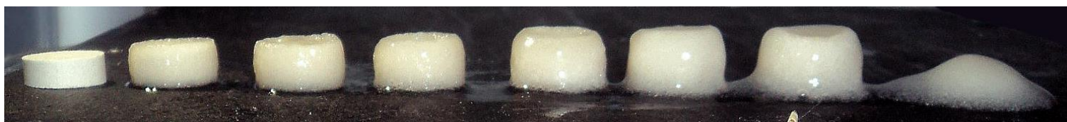
Figura 183. Seguimiento del hinchamiento de las matrices de carragenina – \lambda desde tiempo cero hasta 24 h de exposición en HCl 0.1 N.
