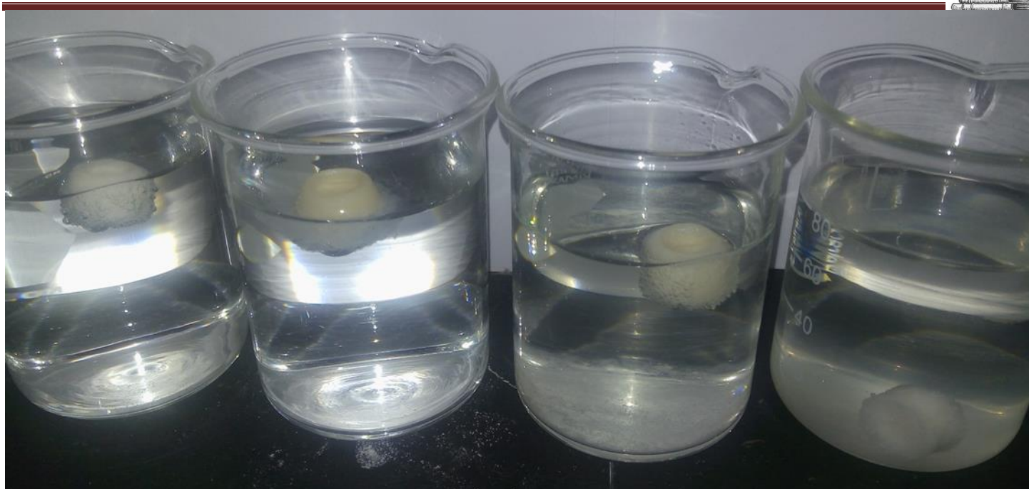
Figura 175. Seguimiento de la flotación e hinchamiento de las matrices de HPMC 100000 40/25, alginato LF 200M 40/25, carragenina \lambda 40/25 y Carbopol® 934 40/25 a 3 h de exposición en HCl 0.1 N.
