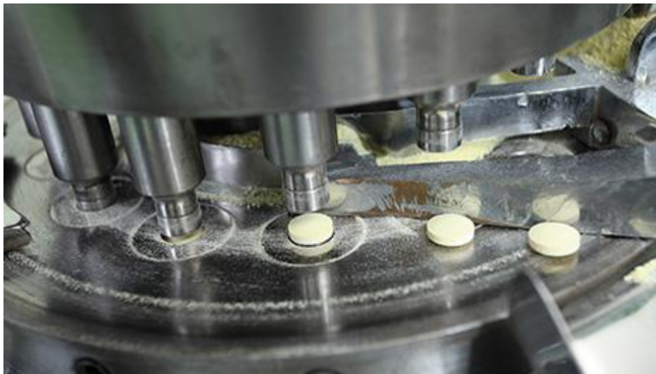
Figura 129. Imagen en tiempo real de la compresión, en una tableteadora rotativa enfatizando las matrices, punzones y comprimidos generados.
