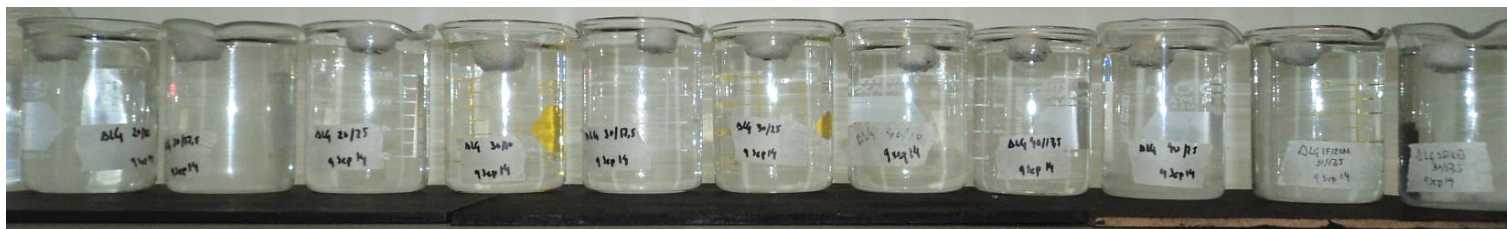
Figura 180. Seguimiento de la flotación e hinchamiento de las matrices de alginato LF 200M a 3 h de exposición en HCl 0.1 N.
