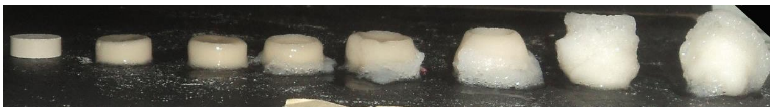
Figura 184. Seguimiento del hinchamiento de las matrices de alginato LF 200M desde tiempo cero hasta 24 h de exposición en HCl 0.1 N.
