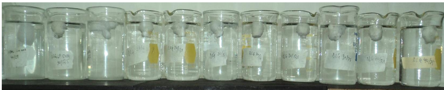
Figura 181. Seguimiento de la flotación e hinchamiento de las matrices de alginato LF 200M y HPMC 100000 a 1 semana de exposición en HCl 0.1 N.
