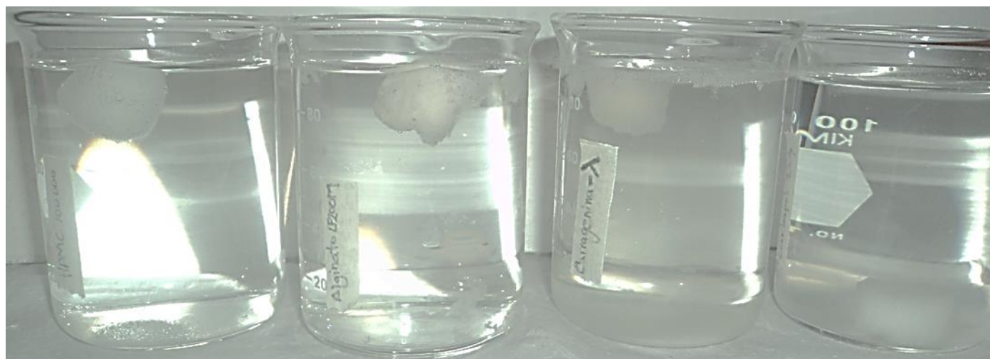
Figura 178. Seguimiento de la flotación e hinchamiento de las matrices de HPMC 100000 40/25, alginato LF 200M 40/25, carragenina \lambda 40/25 y Carbopol® 934 40/25 a 24 h de exposición en HCl 0.1 N.
