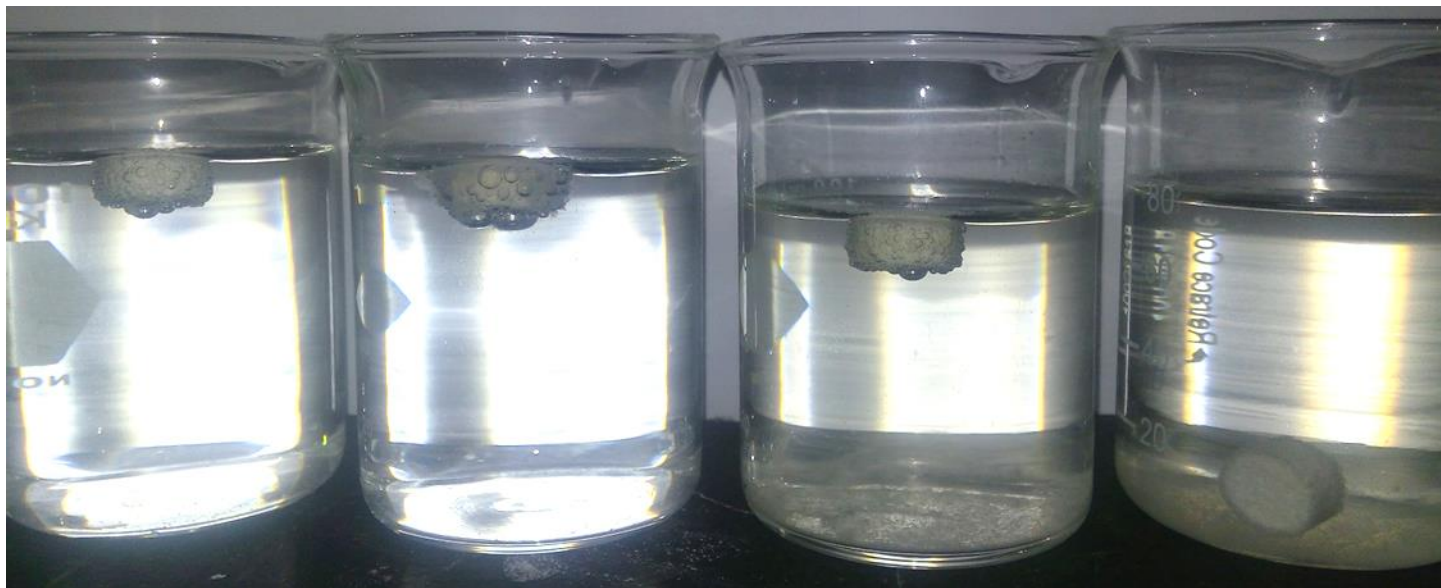
Figura 173. Seguimiento de la flotación e hinchamiento de las matrices de HPMC 100000 40/25, alginato LF 200M 40/25, carragenina \lambda 40/25 y Carbopol® 934 40/25 (respectivamente de izquierda a derecha) a 10 minutos de exposición en HCl 0.1 N.
