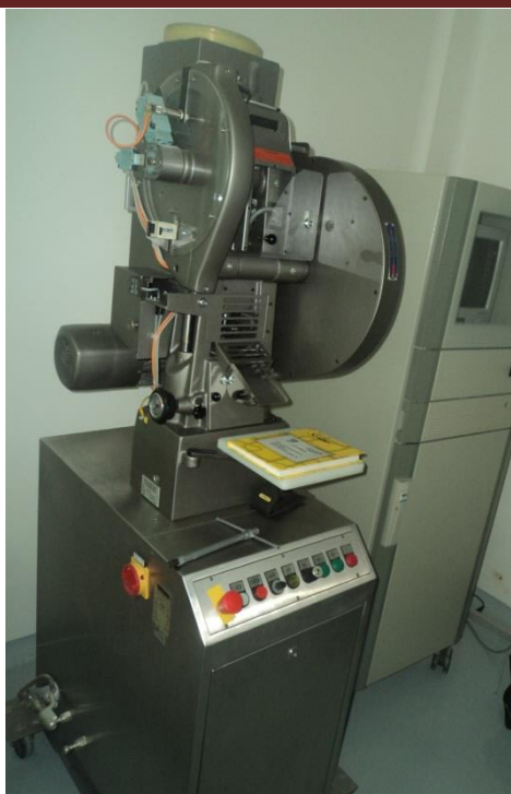
Figura 125. Imagen de una “tableteadora excéntrica EK 0 – DMS” 209 (izquierda) y un “diagrama de las partes de una tableteadora monopunzónica” 210 (derecha).
