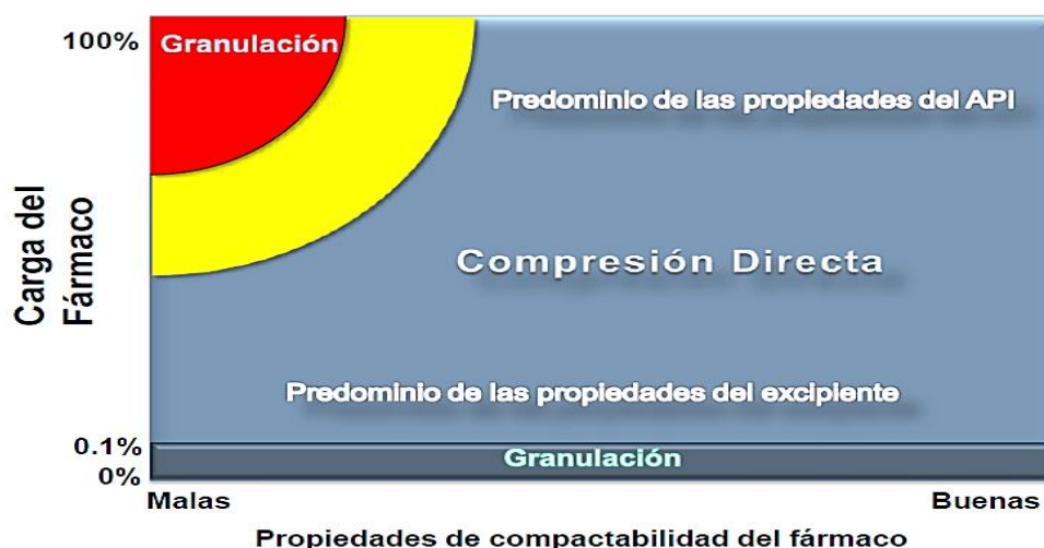
Figura 6. “Zonas de predominio en términos generales para la compresión considerando los factores de carga en la formulación y propiedades de compactabilidad del API.” 12,13
