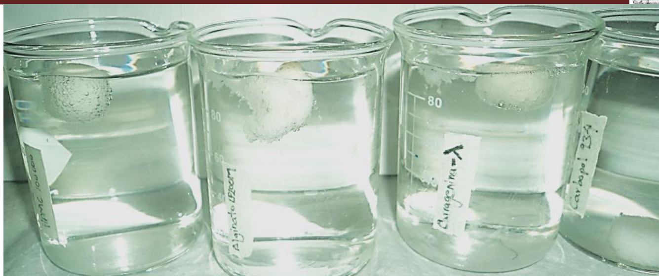
Figura 177. Seguimiento de la flotación e hinchamiento de las matrices de HPMC 100000 40/25, alginato LF 200M 40/25, carragenina \lambda 40/25 y Carbopol® 934 40/25 a 12 h de exposición en HCl 0.1 N.
