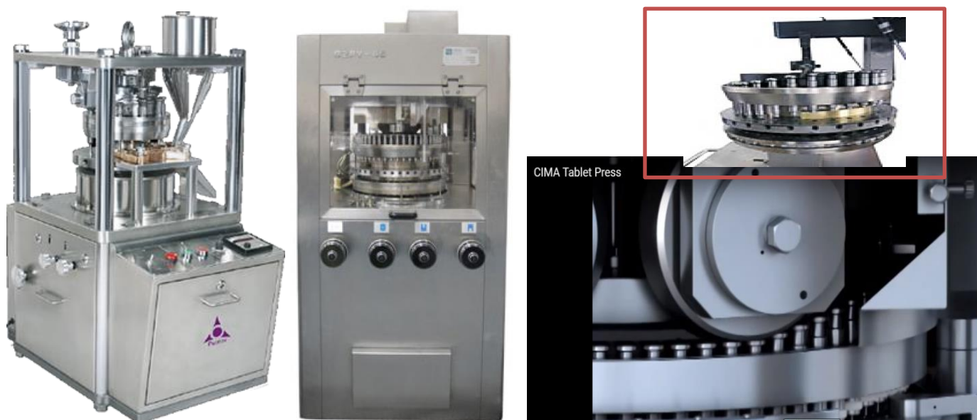
Figura 127. Tableteadoras rotativas de mediana producción en la primera imagen, la segunda imagen muestra una “tableteadora de torretas intercambiables serie GZPY CIMA y en la tercera imagen las torretas, las cuales se pueden intercambiar en 45, 37 y 30 estaciones.” 212
