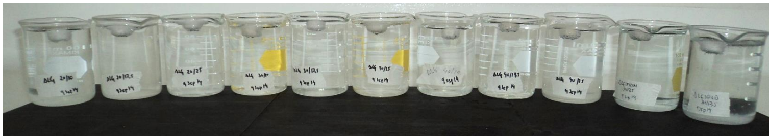
Figura 179. Seguimiento de la flotación e hinchamiento de las matrices de alginato LF 200M a 1 h de exposición en HCl 0.1 N.
