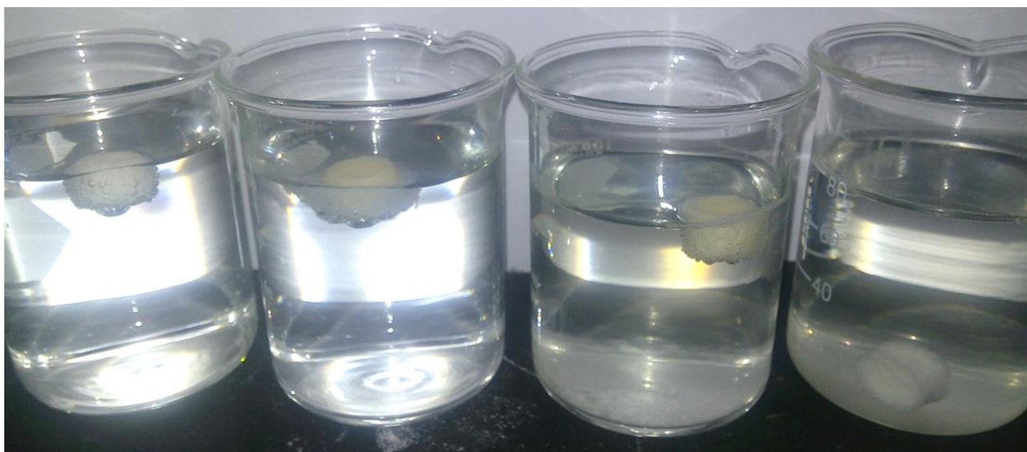
Figura 174. Seguimiento de la flotación e hinchamiento de las matrices de HPMC 100000 40/25, alginato LF 200M 40/25, carragenina \lambda 40/25 y Carbopol® 934 40/25 a 1 h de exposición en HCl 0.1 N.
