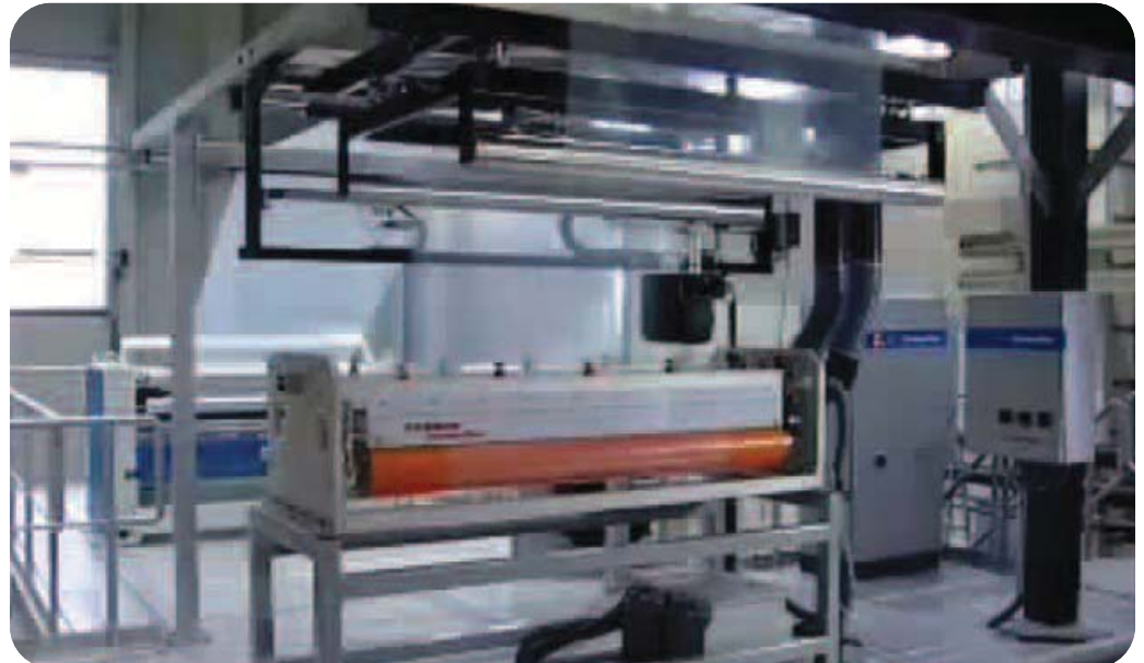
Ilustración 12. Máquina de Tratamiento CORONA. Vetaphone Corona Plus (2013).
