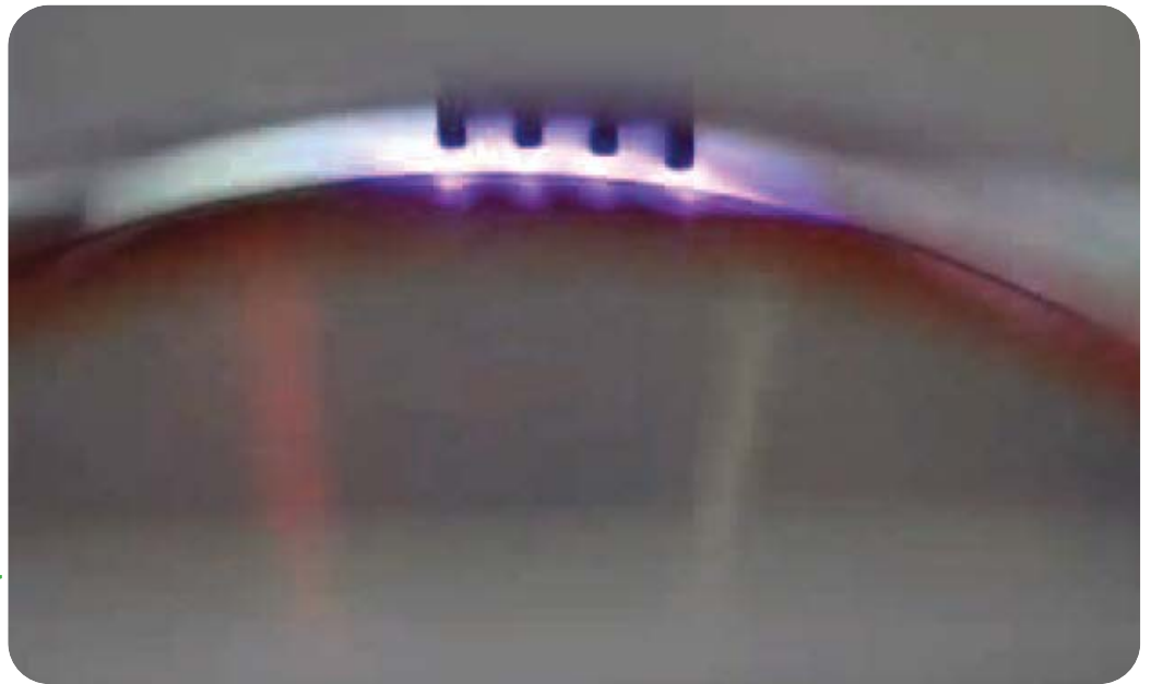
Ilustración 11. Acercamiento al proceso del tratamiento CORONA. Vetaphone Corona Plus (2013).
