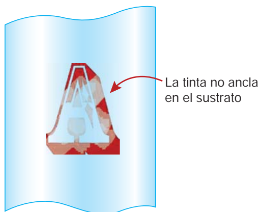
APLICACIÓN DE TINTA SOBRE SUSTRATO SIN TRATAMIENTO CORONA
