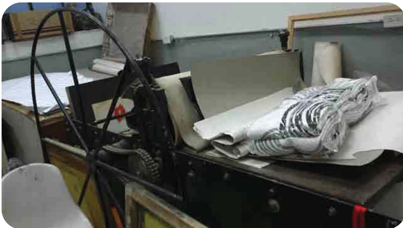
Ilustración 53. Tórculo de impresión. Taller de Gráfica de la Academia de San Carlos UNAM.
