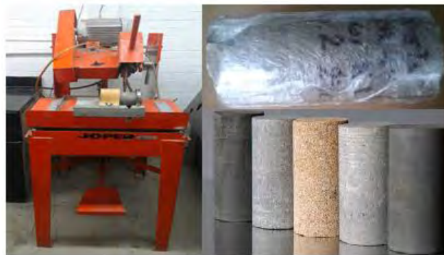
Figura 2 Cortadora de núcleos
