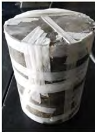
Figura 32 Muestra de diámetro completo con relleno.
