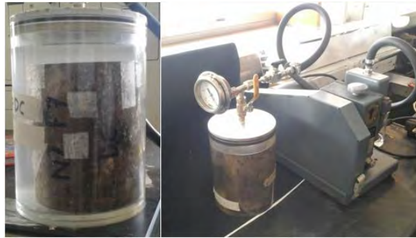
Figura 45 Sistema de cápsula hermética y bomba de vacío para saturación en un núcleo inmerso en salmuera
