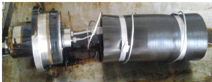
Figura 41 Núcleo en manga de neopreno conectada al tapón de la celda de confinamiento
