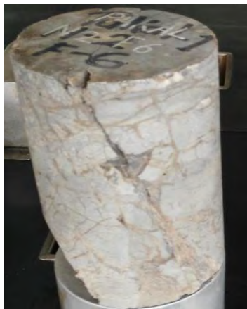
Figura 38 Núcleo carbonatado naturalmente fracturado de diámetro completo
