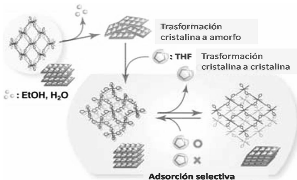
Figura 1.4.2: Transformación estructural, de cristalina a amorfo, o de cristalina a cristalina, inducida por la inclusión de moléculas. 28a
