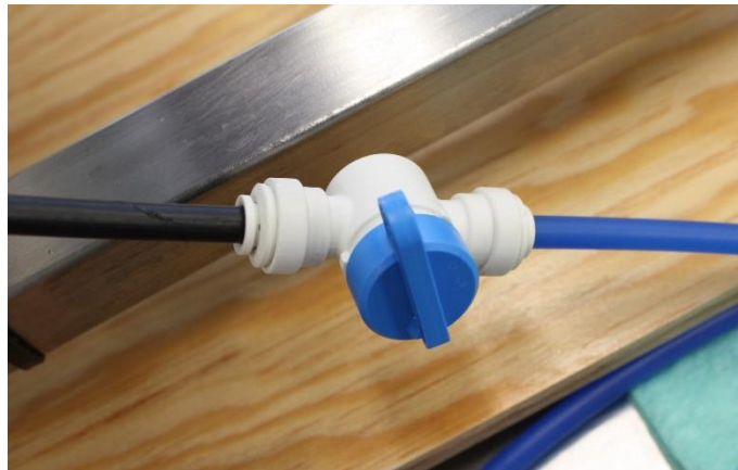
Válvula de control de rechazo
