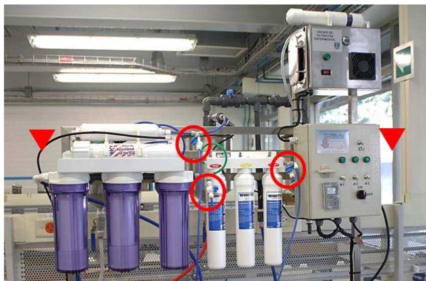
Figura 4.3 Localización de los sitios de muestreo para cada réplica de los tratamientos.
