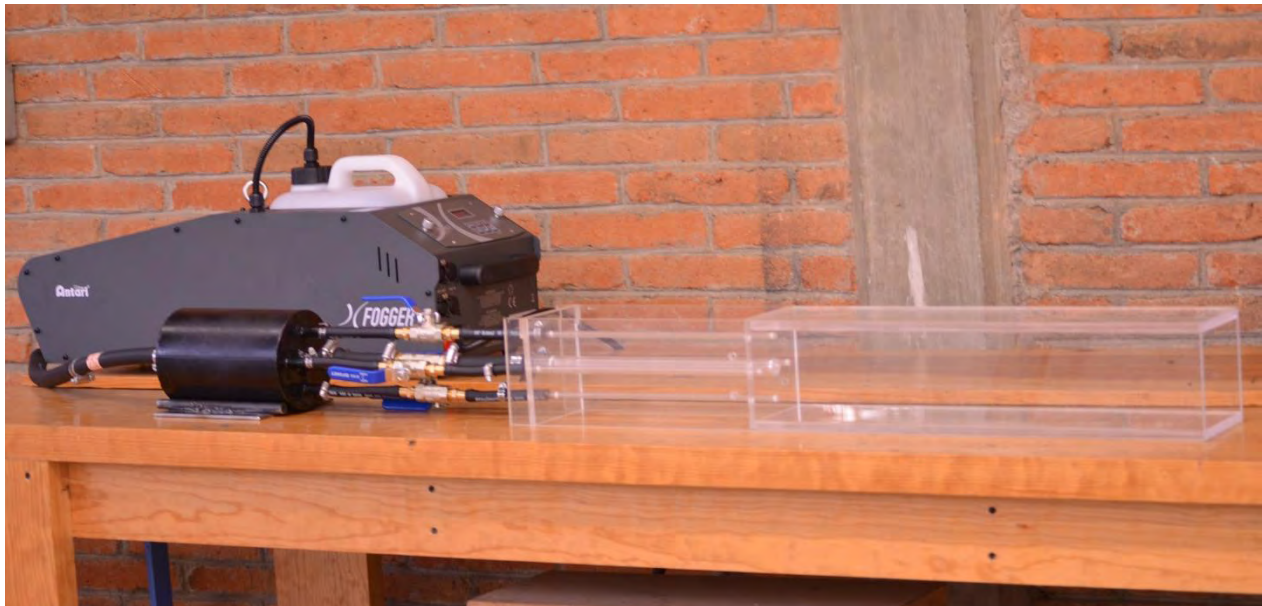
Figura 5.1. Unidad generadora de niebla.
