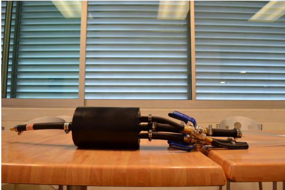
Figura 4.6. Conexión de válvula-inyección.
