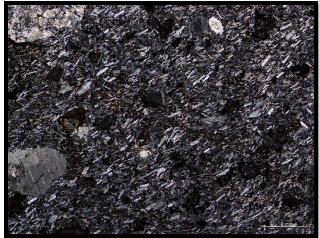
Figura A7. Roca basalto presenta textura porfídica y microlítica. Se observan minerales grandes embebidos en una matriz microlítica (Plagioclasas), y estas presentan un grado de oxidación.
