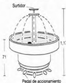
4 Lavamanos tipo fuente. Ocupa un 25 % menos de sitio que el sistema lineal → 7 + 11
