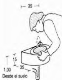
1 Fuente-surtidor para beber. Accionamiento con palanca manual, a menos de 100 m del puesto de trabajo
