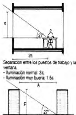
② Separación adecuada entre edificios para conseguir una buena iluminación interior - Iluminación normal: 2a - Iluminación muy buena: 1,5a
