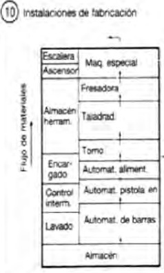
13 Dirección de ampliación en perpendicular al flujo de materiales
