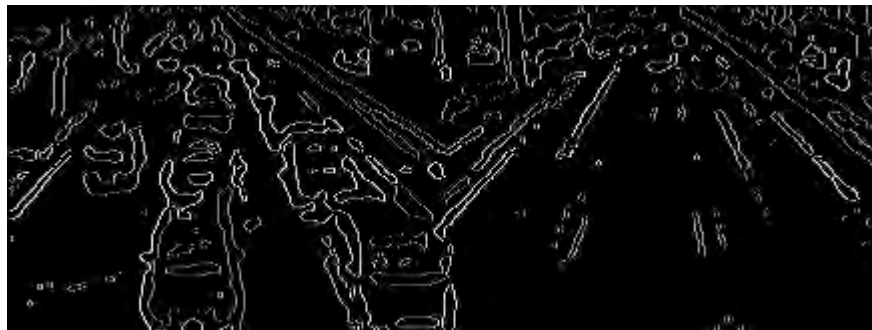
Figura 3.6. Bordes detectados en las imágenes de muestra por el medio del algoritmo de Canny.
