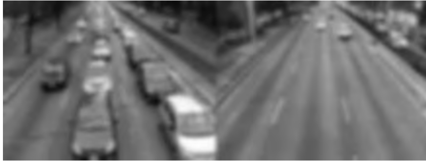
Figura 3.3. Muestra de imágenes con un filtro Gaussiano.
