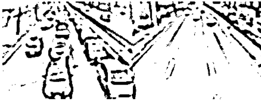
Figura 3.5. Muestra de imágenes binarias haciendo uso de un umbral calculado con un filtro adaptativo gaussiano.
