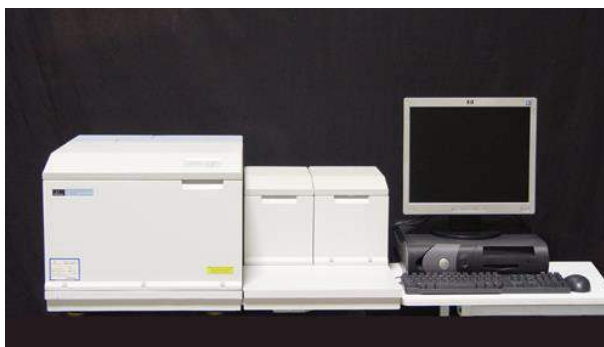
Fig.40. Equipo para el análisis de Espectrometría Infrarroja con Transformada de Fourier (FTIR)
