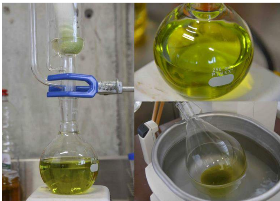
Fig.39. Extracción de lípidos neutros vía Soxhlet y recuperación del solvente.
