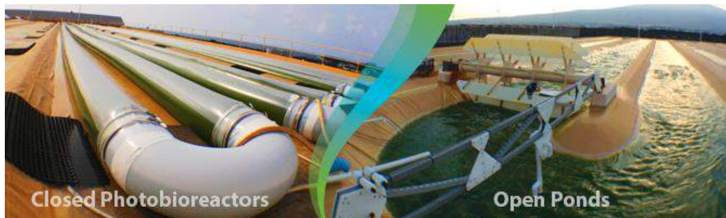
Fig. 21. Combinación de sistemas abiertos y cerrados en un mismo proceso. Recuperado de (Cellana 2016).
