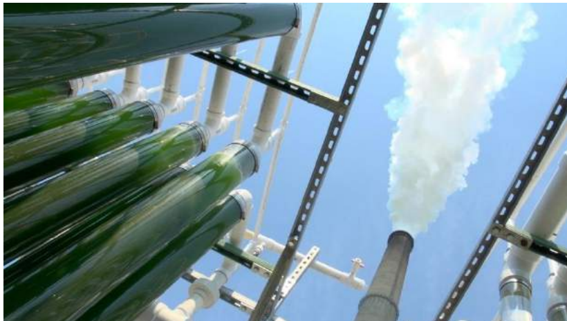
Fig.7. Sistema de microalgas para la captura de emisiones de CO 2 provenientes de una planta carboeléctrica. Recuperada de ( Hautala 2013 ).
