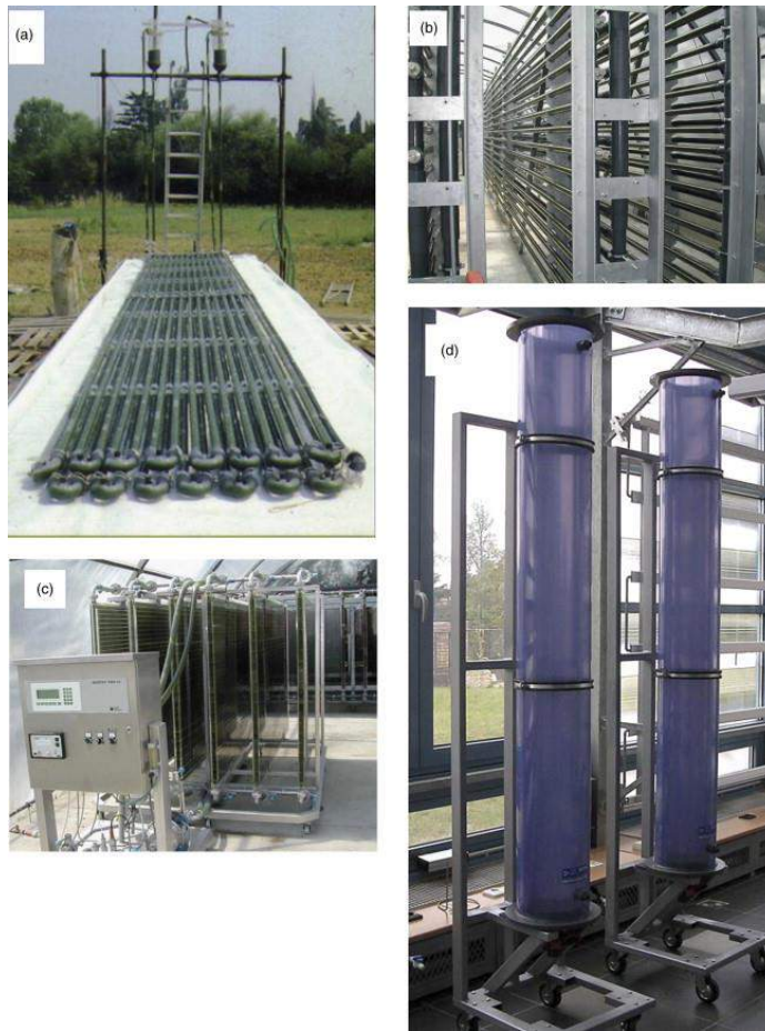
Fig.16. Sistemas cerrados para el cultivo algal. a) FBR tubular horizontal, b) FBR horizontal en “pared vertical”, c) FBR en serie de panel vertical, d) FBR de columna. Adaptado de (Masojídek y Torzillo 2008).
