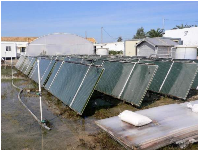
Fig. 18. Fotobiorreactores planos en el sur de Portugal. Recuperada de (Necton 2013).
