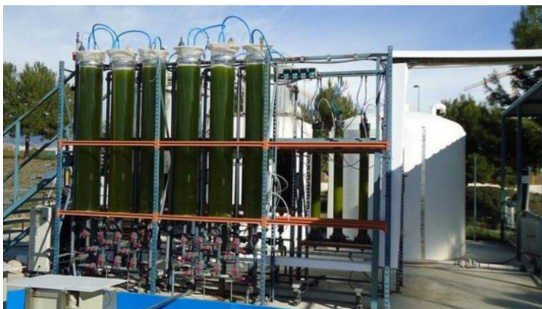
Fig.19. Fotobioreactores de columna en Alicante, España. Recuperada de (Yeomans 2013).
