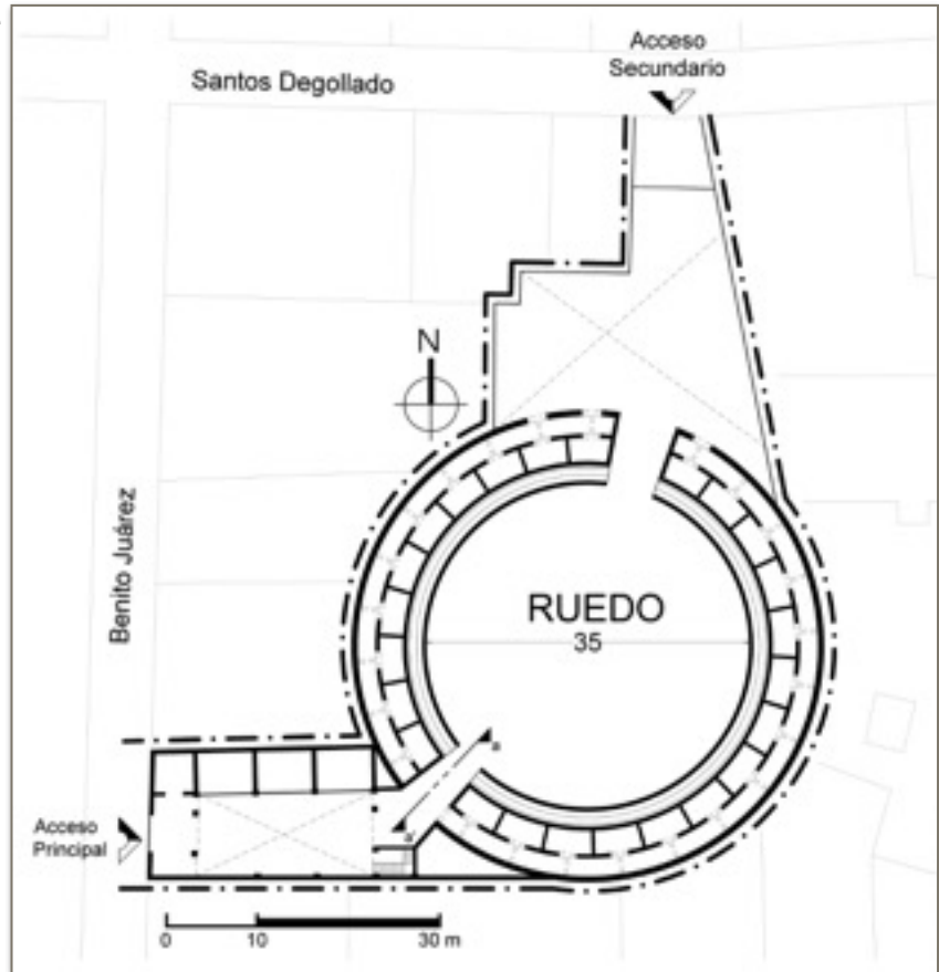
Imagen 75. Plano de la plaza de toros "La Macarena" en Salvatierra, Gto. Se observa la disposición del acceso y el pasillo perimetral.
