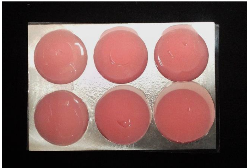
Figura 7 Colocación de acetato para colocar Tapa y prensar
