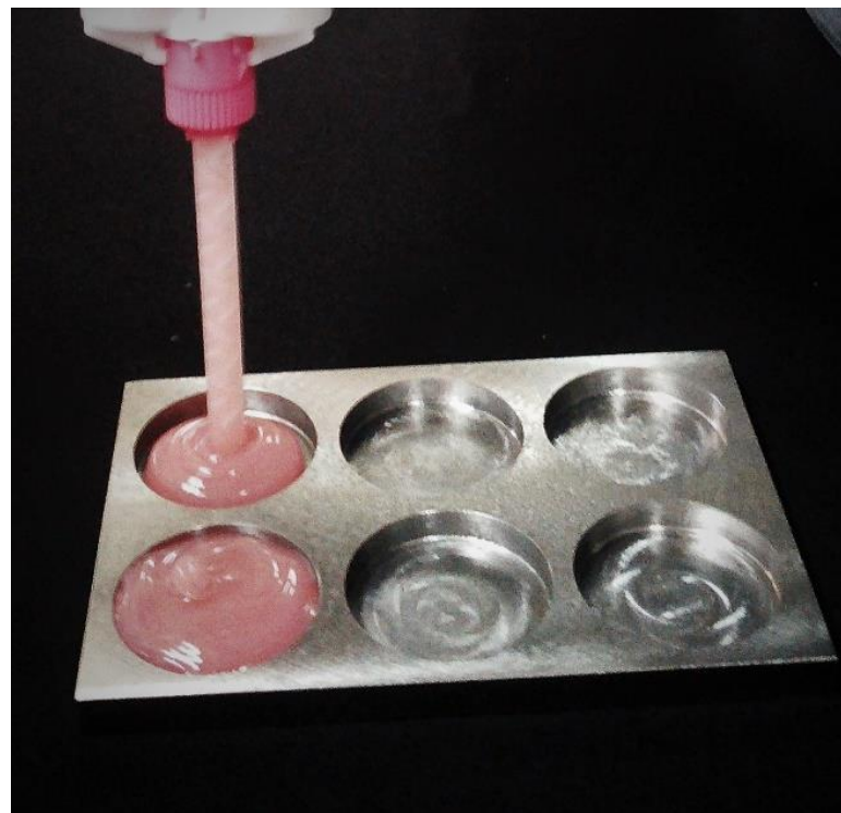
Figura 6 Colocación del material en los moldes
