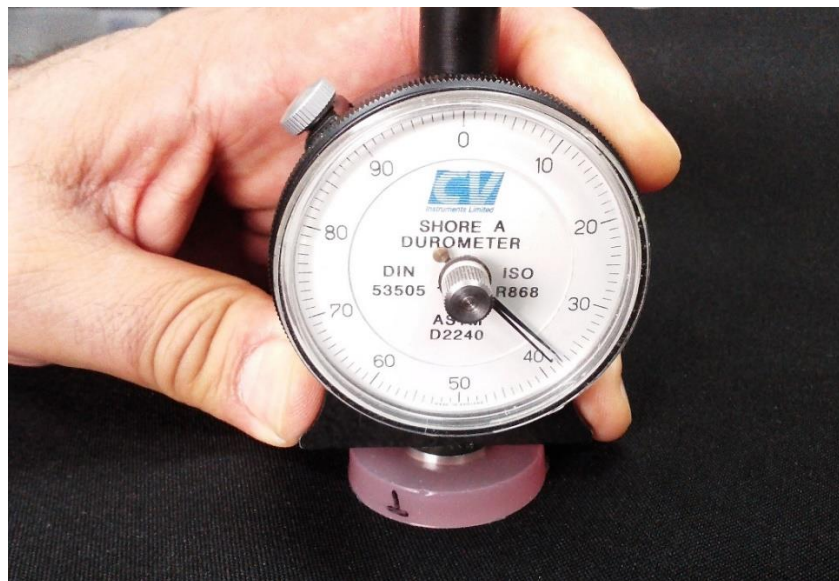
Figura 12 Medición de Dureza Shore A a 24 hrs.
