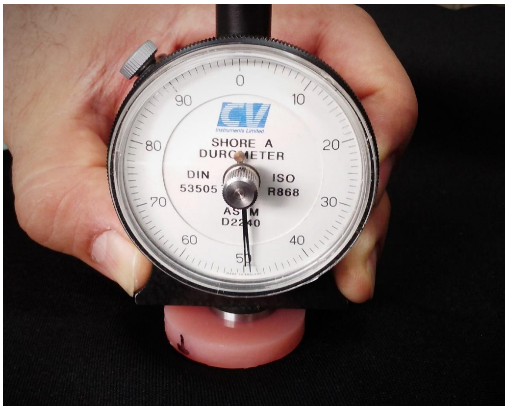
Figura 13 Medición de Dureza Shore A a 28 días
