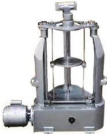
Fig 1.3 Shaker mecánico (“Laboratory mechanical shaker”, Vidiac)
