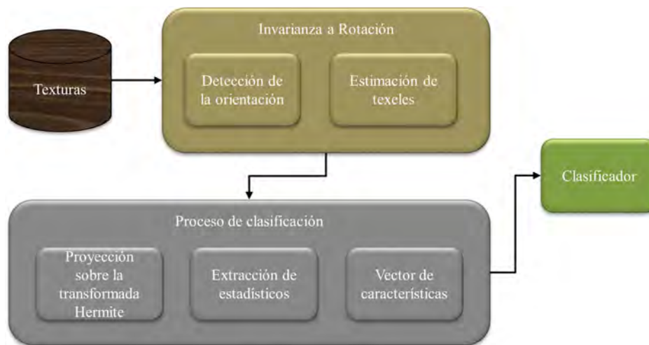
Figura 4.1: Diagrama a bloques de la metodología para la estimación del texel y extracción de características con SHT multiescala.
