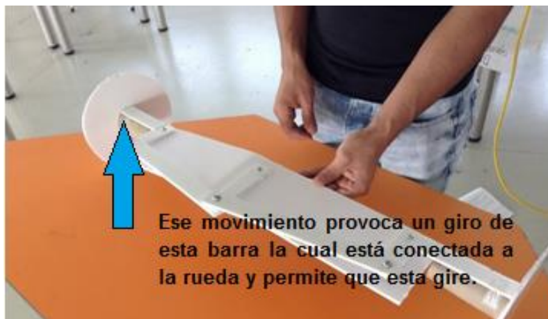
Figura 6.14. Modelo funcional de dirección 2.
