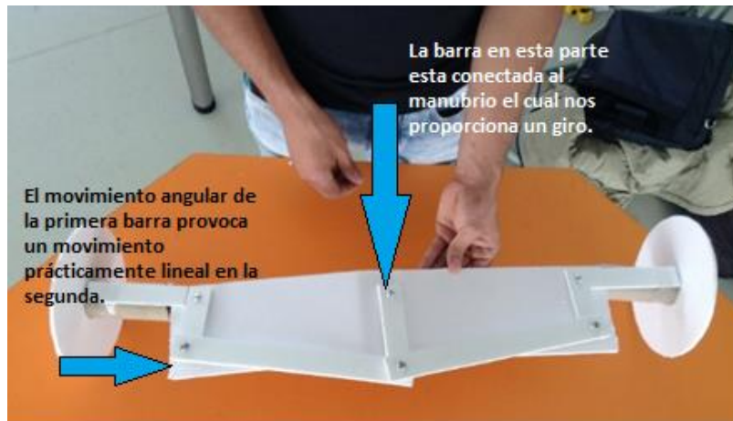
Figura 6.13. Modelo funcional de dirección 1.
