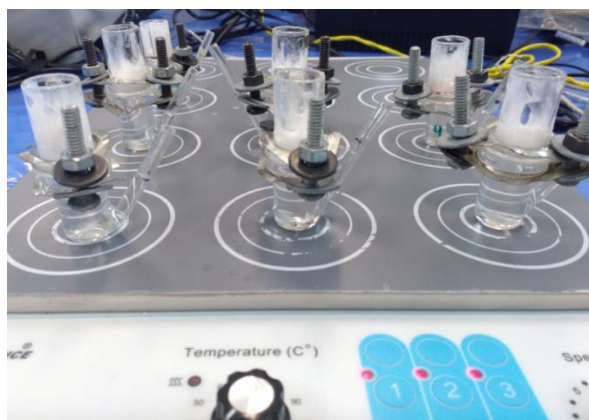
FIGURA 32. TÉCNICA DE PERMEACIÓN IN VITRO CON CELDAS TIPO FRANZ PARA LA DETERMINACIÓN DE LA CANTIDAD ACUMULADA DE AMK.
