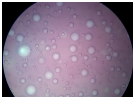
FIGURA 22. EMULSIÓN O/W DETERMINADA UTILIZANDO UN COLORANTE LIPOFÍLICO (EN ETANOL) VISTA EN EL MICROSCOPIO A 10X.
