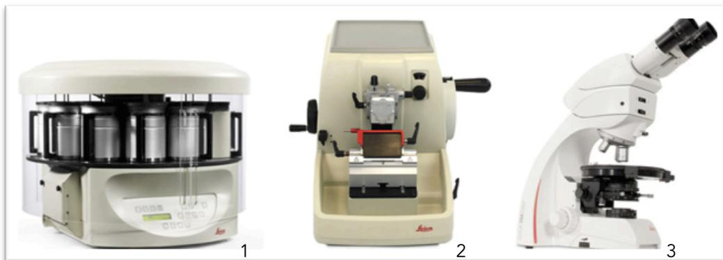
Figura 3. Equipamiento utilizado para el procedimiento de laboratorio: 1) Cambiador automático Leica TP1020; 2) Microtomo rotatorio Leica RM2125RT; 3) Microscopio óptico Leica DM 750.
