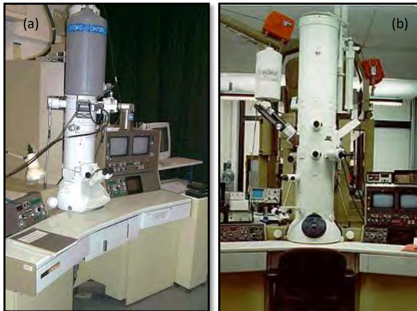
Figura 2.10. a) TEM JEM1200EX, 30kV, resolución ~ 10 nm, b) HRTEM JEM 4000EX, 400kV, resolución ~ 0.1 nm.
