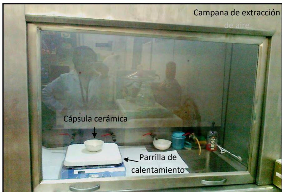
Figura 3.14. Montaje experimental de la síntesis por combustión.
