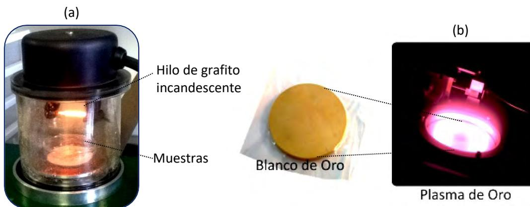
Figura 2.5. Método para realizar el recubrimiento de muestras no conductoras: a) vía carbon coater y b) sputtering, utilizando un blanco de oro puro.
