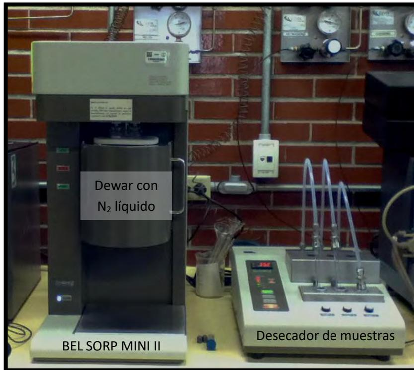
Figura 2.15. Equipo para realizar la medición de área superficial.
