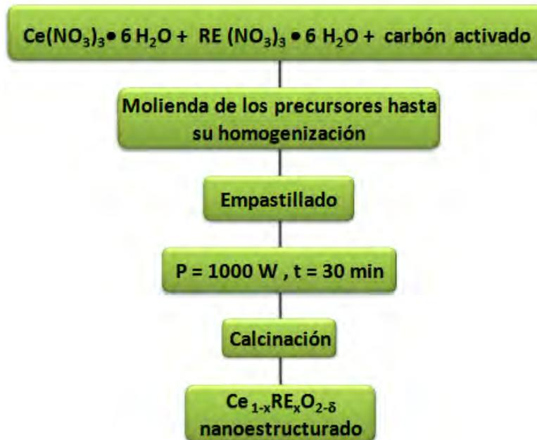
Figura 3.21. Diagrama de la síntesis asistida por microondas.
