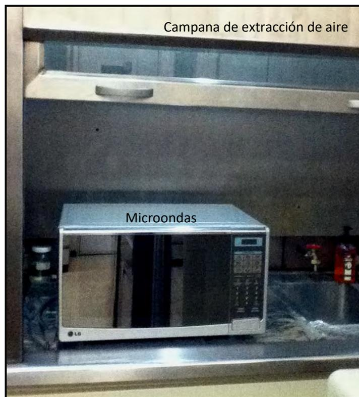
Figura 3.19. Montaje experimental para realizar la síntesis asistida por microondas.
