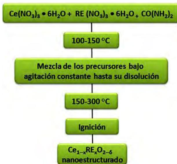
Figura 3.16. Diagrama esquemático de la síntesis por combustión para la obtención de los óxidos nanoestructurados de ceria dopada.
