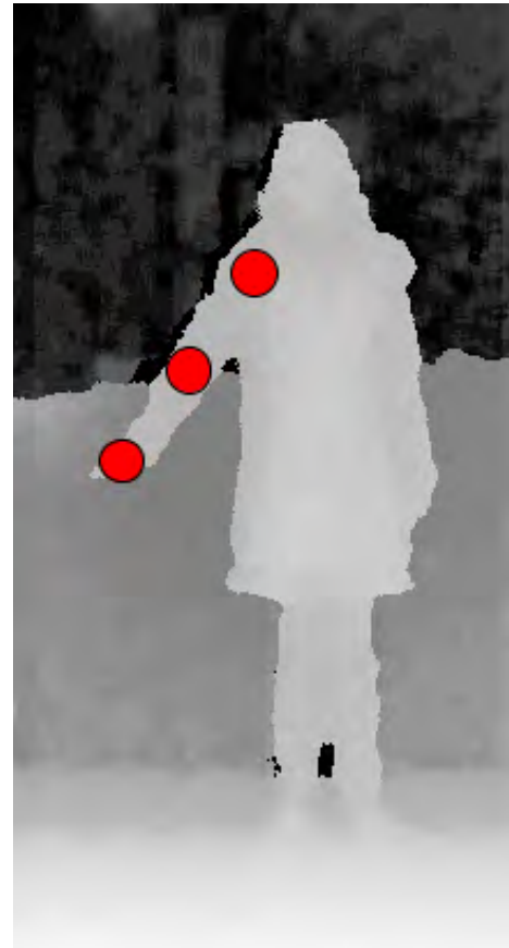
Figura 28. Visión de infrarrojo del Kinect. Se observan la localización del brazo derecho (hombro, codo y mano) de una persona.
