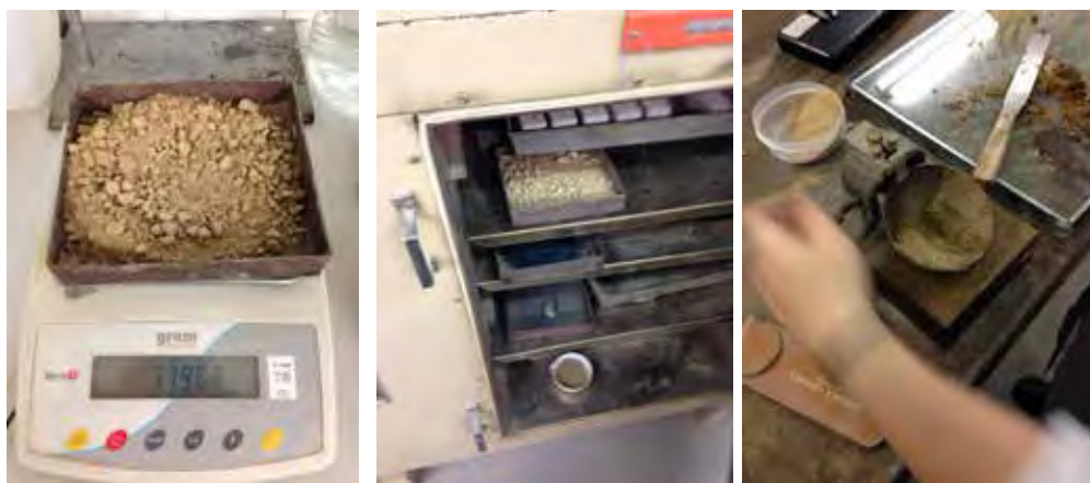
^^ figura 73. Tablas para caracterizar la tierra según las normas españolas UNE 103 300 93 humedad / UNE 103 104 93 limite plástico / UNE 103 103 94 limite líquido.
