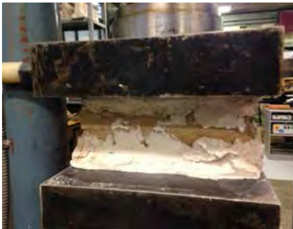
^ figura 83. Imagen de probeta M3 al obtener la resistencia a compresión máxima.
