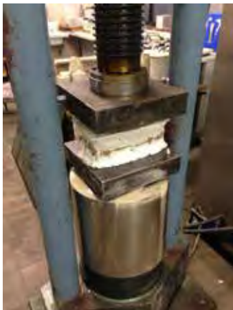
^ figura 82. Imagen de probeta M3 en prensa para obtener la resistencia a compresión máxima.
