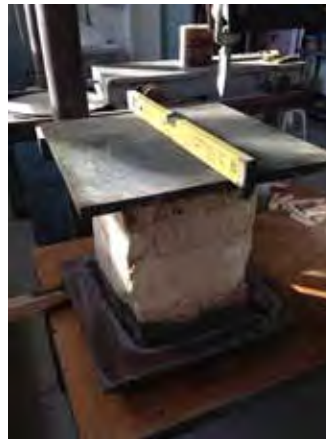
^ figuras 68 . Refrentado de bloque A1
