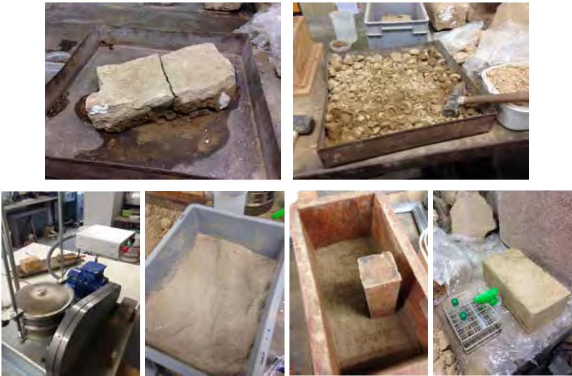
^ figuras 76. Imágenes del proceso de probetas experimentales. (obtención de la tierra a través de absorción por capilaridad y machacar el bloque de tierra - tamizado de tierra - vaciado de la tierra, inserción de bacteria y compactación)
