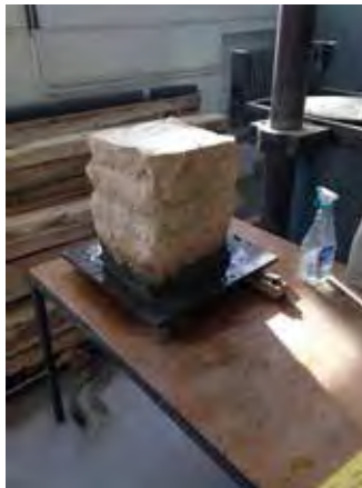
^ figuras 68 . Refrentado de bloque A1
