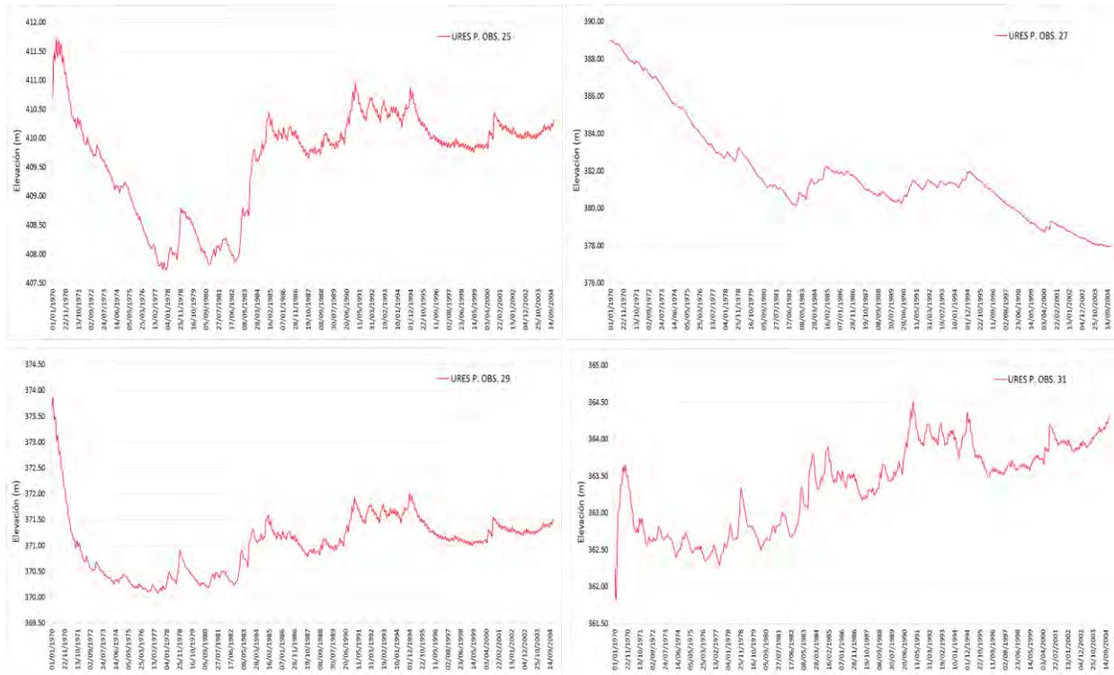
Figura 5.29 Evolución temporal de la carga piezométrica en pozos de observación localizados en el acuífero Valle de Ures
