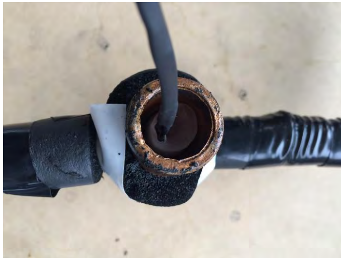
Figura 3.6. Hielo formado alrededor del termopar
