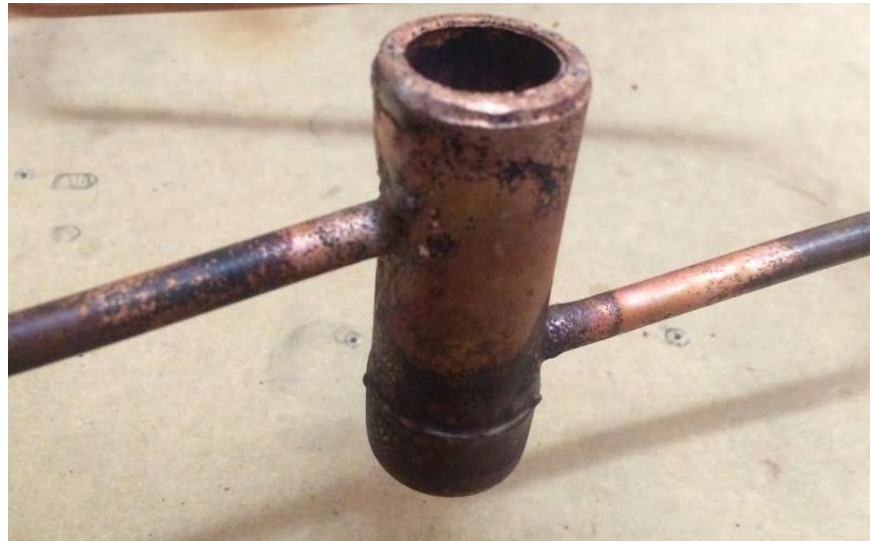
Figura 3.2. Molde evaporador de cobre soldado
