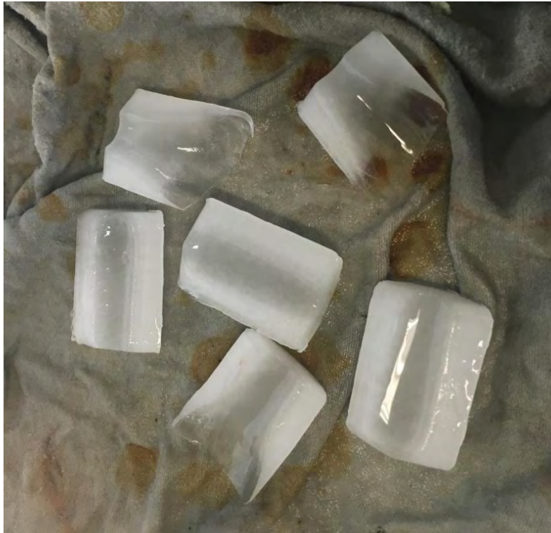
Figura 4.10. Hielos formados en 8 minutos con pre enfriamiento del molde.
