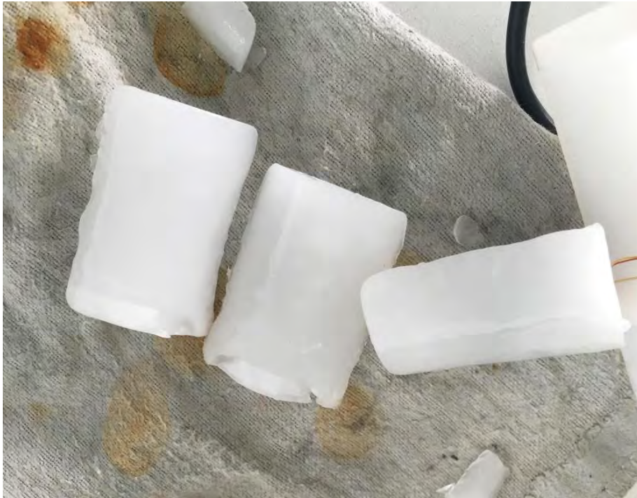
Figura 4.9. Hielos formados en el molde sin pre enfriamiento durante la cuarta prueba.
