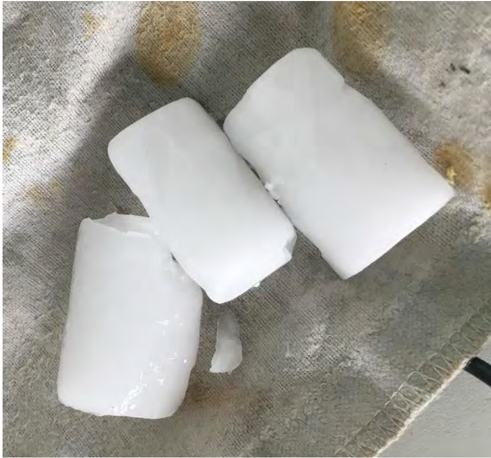
Figura 4.7. Hielos formados en el molde con pre enfriamiento durante la tercera prueba.
