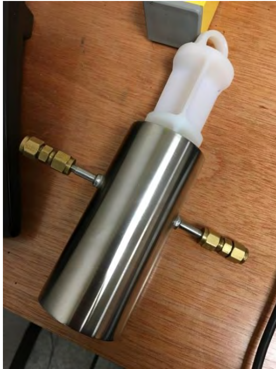
Figura 3.9. Segundo prototipo del molde evaporador
