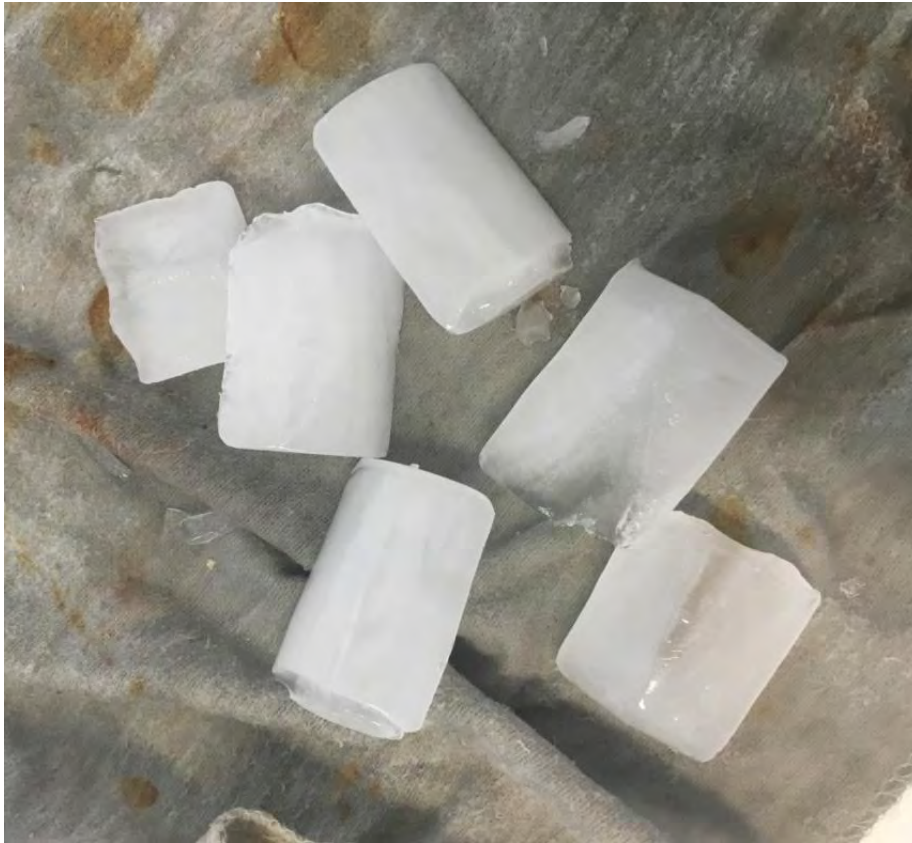
Figura 4.5. Hielos formados en el molde sin pre enfriamiento durante la segunda prueba.
