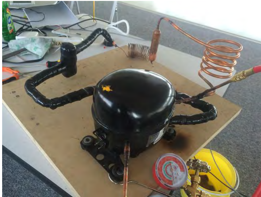
Figura 3.4. Sistema con el tubo del evaporador aislado
