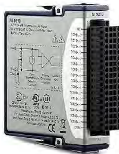
Figura 4.1. Tarjeta de Adquisición para registrar las temperaturas
