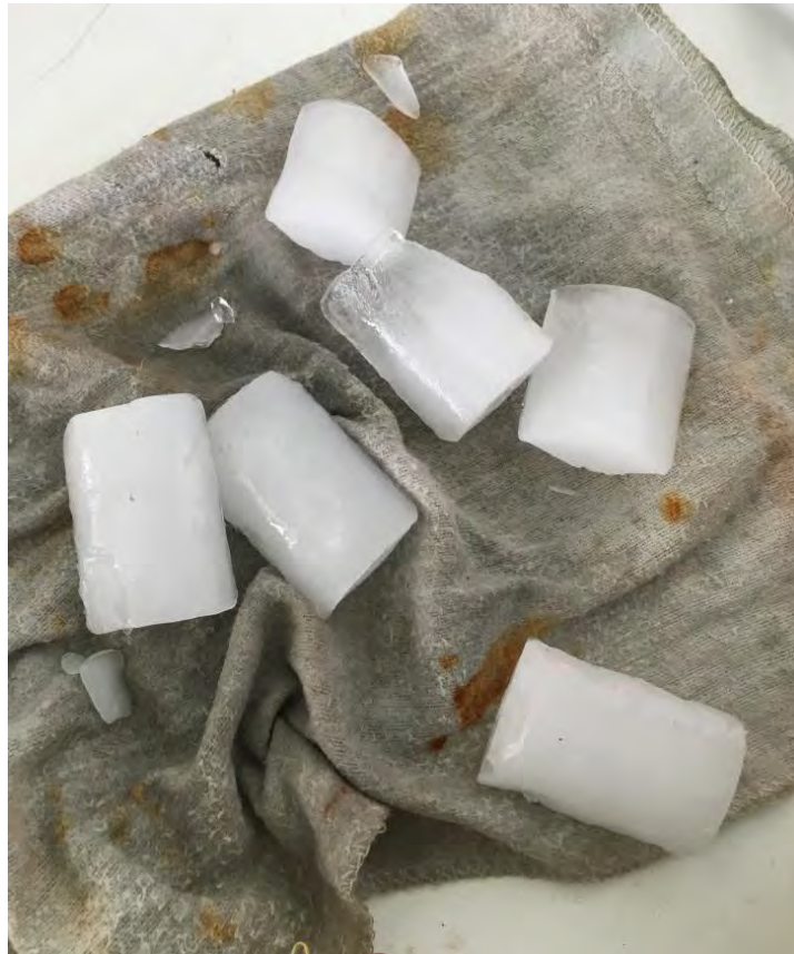
Figura 4.3. Hielos formados en el molde con pre enfriamiento durante la primera prueba
