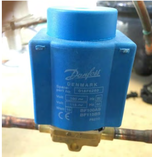
Figura 3.10. Válvula solenoide utilizada para el desmolde
