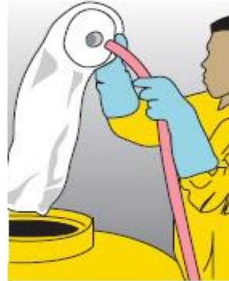
Se deja el bambú por un mínimo de una hora en la cuenca de la solución para vaciar por completo de cañas en el agujero del sumidero. Se bombea la solución sobrante en el recipiente a través de un filtro para su reutilización. El filtro debe ser cambiado regularmente. Hay que hacer pruebas con el hidrómetro y añadir más bórax y ácido bórico en caso necesario. Se limpia toda la caña para eliminar el exceso de borato.
