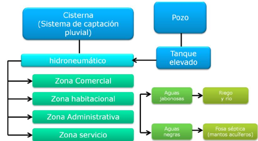
Una red de distribución principal de agua potable fría proveerán de agua a los lavabos, fregaderos y duchas, y un ramal alimentara a los calentadores solares u caldera para proveer de agua caliente; se utilizará el agua pluvial, para jardines y suministro de las cisternas de servicio; la
