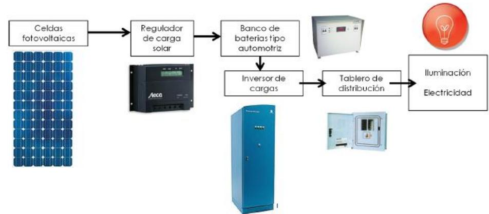
Esquema de funcionamiento de sistema de electricidad generada con celdas solares
