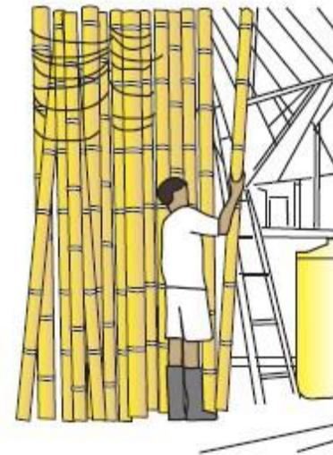
Se tiene que mover el bambú para la cuenca de concreto. Poniéndose de pie en posición vertical, se atan las cañas bien juntas para que no se pueden mover cuando se llenan con el bórax / Solución de ácido bórico. Las cañas se vuelven muy pesadas cuando están llenas.
