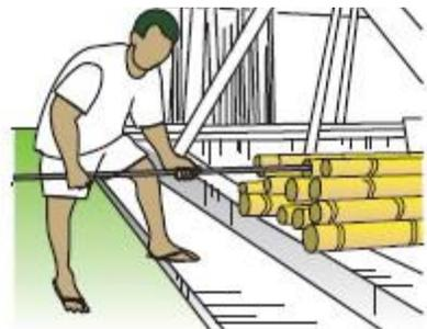
Se coloca el bambú contra una pared. Después se inserta la varilla de hierro y los agujeros de perforación a través de los nodos. Asegurándose de que el último nodo no está pinchado.
