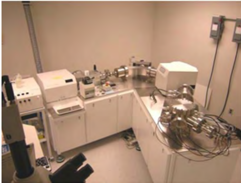
Figura 6. Nu HR ICPMS en el laboratorio LaserChron, Universidad de Arizona.
