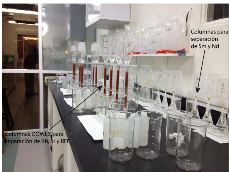
Figura 3. Columnas de intercambio iónico, para separar Rb, Sr y tierras raras (izquierda) y columnas para separar Sm y Nd (derecha).
