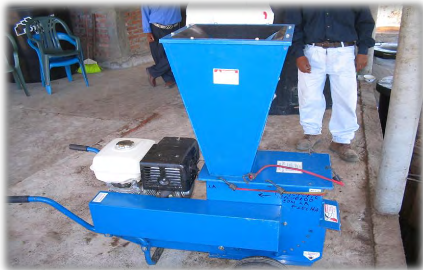
Ilustración 43: Máquina de extracción de piñas para proceso de molienda industrializado. Etapa, producción: fase, molienda (caso de proceso no sustentable, no acorde con la NOM-070-SCFI-1994)
