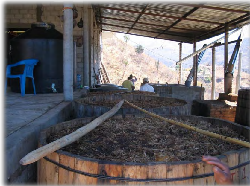
Ilustración 45: Tinajas de fermentación. Etapa, producción: fase, fermentación aeróbica
