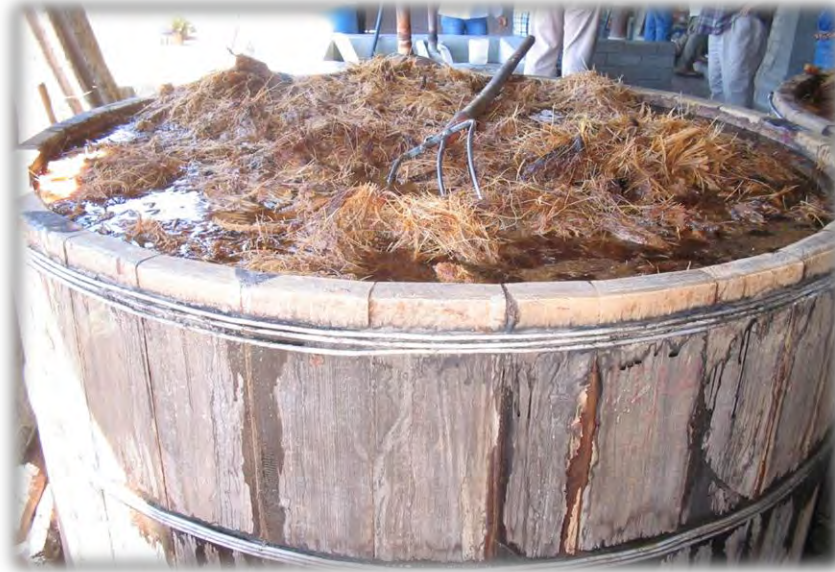
Ilustración 45: Tinajas de fermentación. Etapa, producción: fase, fermentación aeróbica
