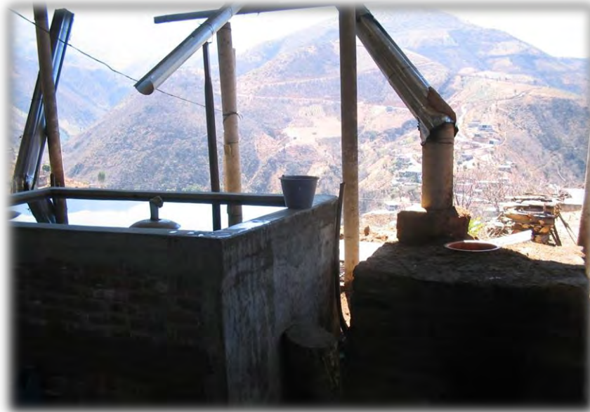
Ilustración 48: Tina y alambique rústicos (susceptibles de contaminación) Etapa, producción: fase, preparación destilación
