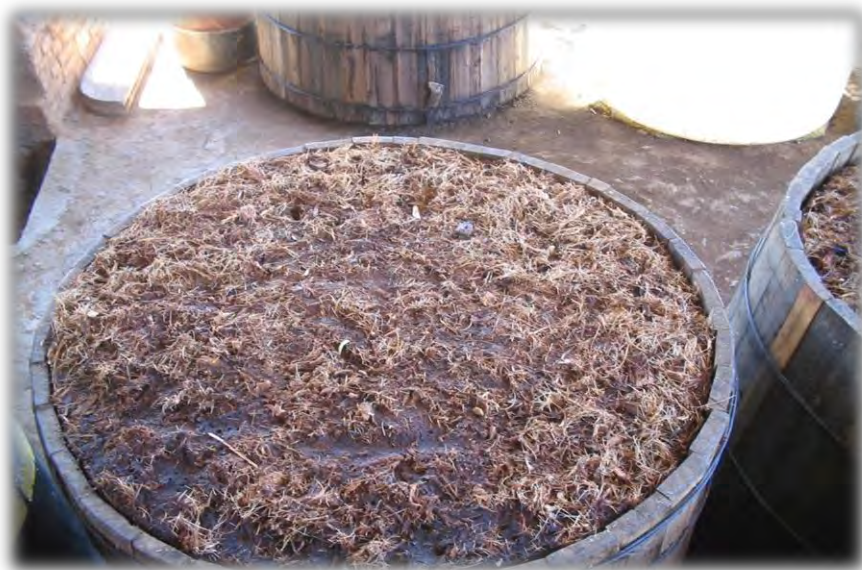
Ilustración 47: Tina de fermentación controlada. Etapa, producción: fase, fermentación producción de alcohol y etanol
