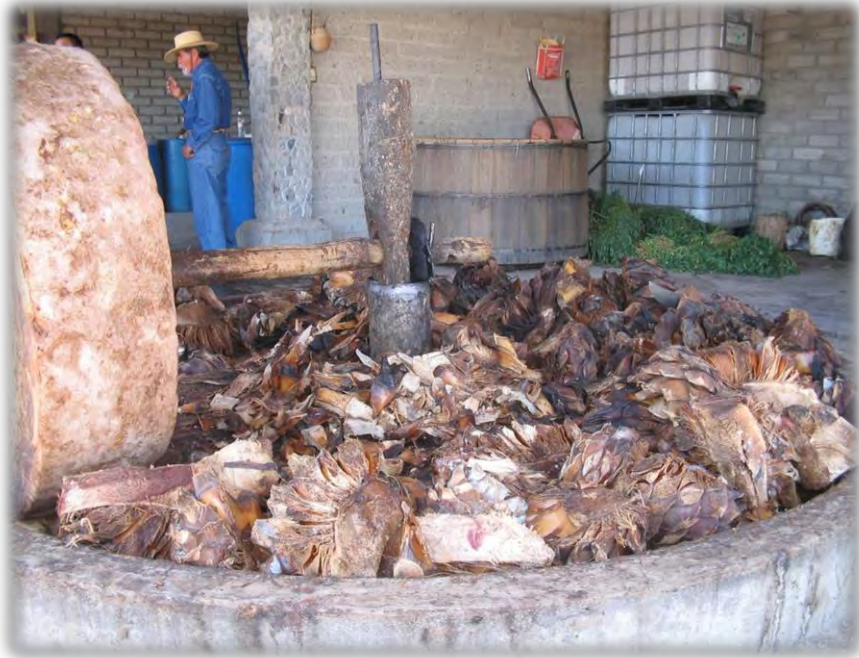
Ilustración 42: Piñas para proceso de molienda artesanal, con rueda de piedra. Etapa, producción: fase, molienda
