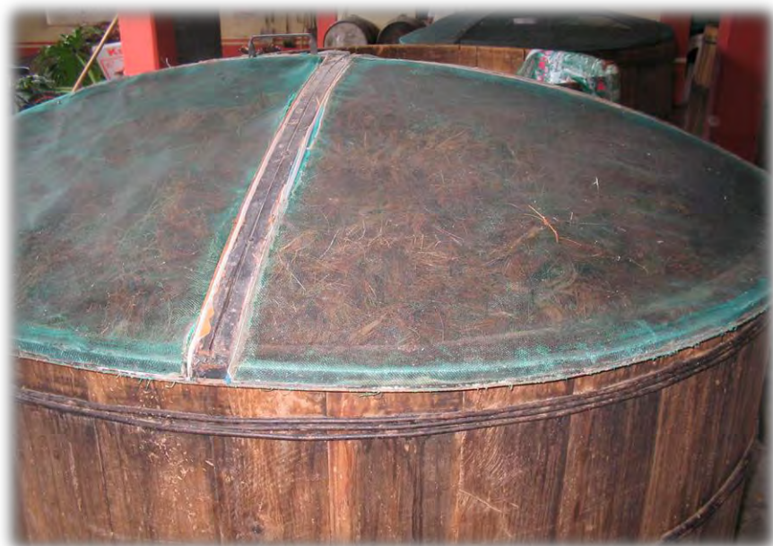
Ilustración 47: Tina de fermentación controlada. Etapa, producción: fase, fermentación producción de alcohol y etanol
