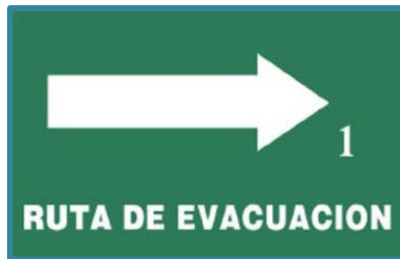
Fig. 21 Señalización para indicar la ruta de evacuación sugerida por la NOM-026-STPS-2008.
