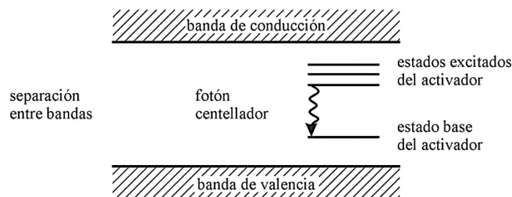
Figura V.5. Estructura de bandas de energía de un centellador cristalino activado.
