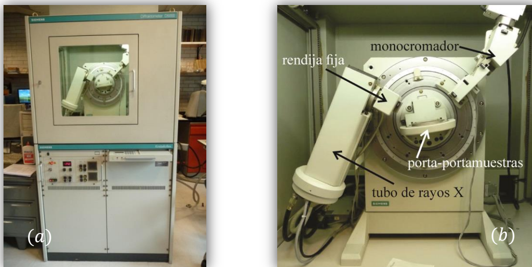
Figura VIII.7. (a) Difractómetro de rayos X Siemens D5000 (b) goniómetro \theta-2\theta incluyendo monocromador de grafito, tubo de rayos X, rendija de divergencia fija y porta-portamuestras.
