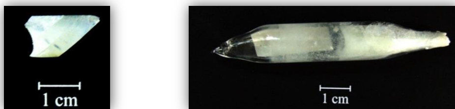
Figura VIII.2. Cristal de \text{KBr}:\text{RbBr}:\text{Eu}^{2+} fuera y dentro de la ampollita de \text{SiO}_2 , respectivamente.
