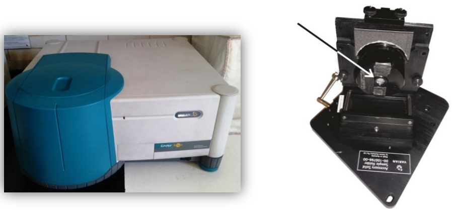
Figura VIII.11. Fotos del fluorímetro Cary Eclipse (izquierda) y su portamuestras (derecha), donde ha montado la muestra.
