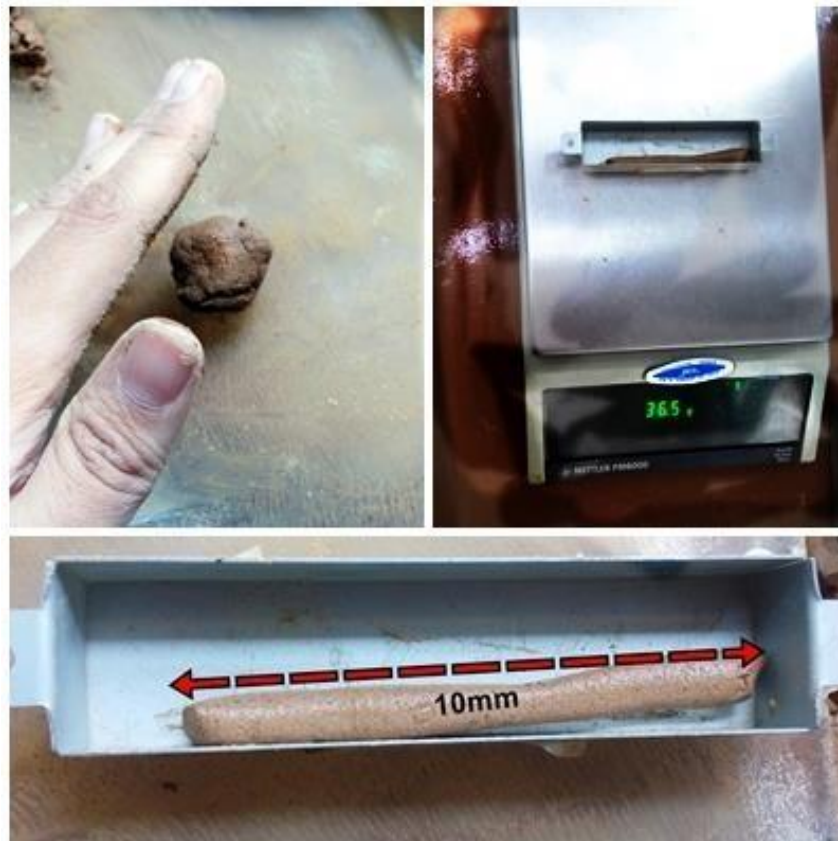
Figura 2.16. Procedimiento para determinar el límite de plasticidad.
