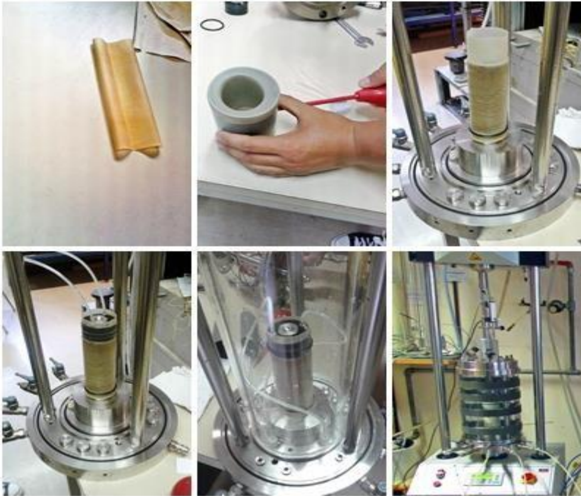
Figura 2.20. Colocación de la muestra en la cámara interior e instalación de la cámara triaxial.
