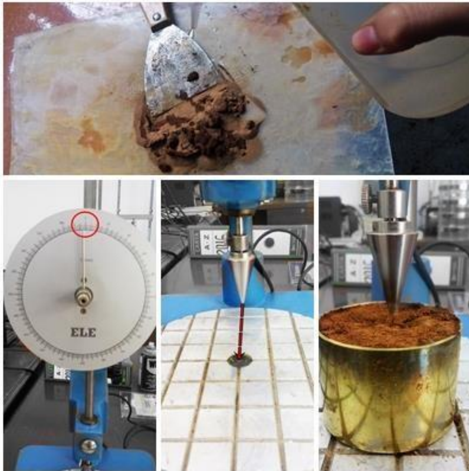
Figura 2.14. Procedimiento para la determinación de los límites de Atterberg con el Cono de Caída.
