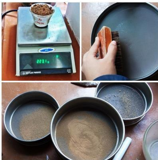
Figura 2.11. Procedimiento de la prueba de granulometría por mallas.
