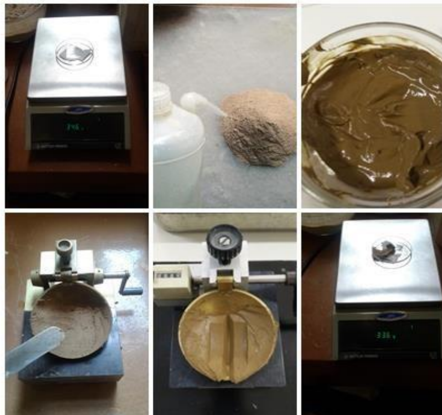
Figura 2.12. Procedimiento para la determinación de los límites de Atterberg con la Copa de Casagrande.
