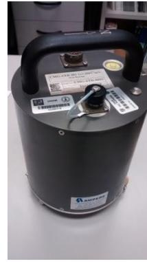
**Figura 4-2. Sismómetro de banda ancha.**
