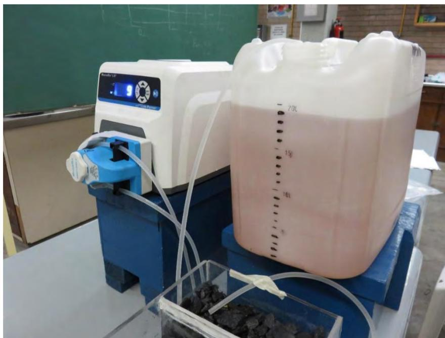
*Figura 5.3. Garrafa de 20 litros de capacidad y bomba peristáltica usada a 9 rpm.*
