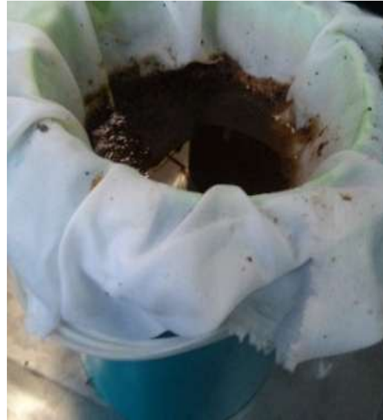
Figura 20B. Lavado de la malta después del proceso de hidrólisis alcalina
