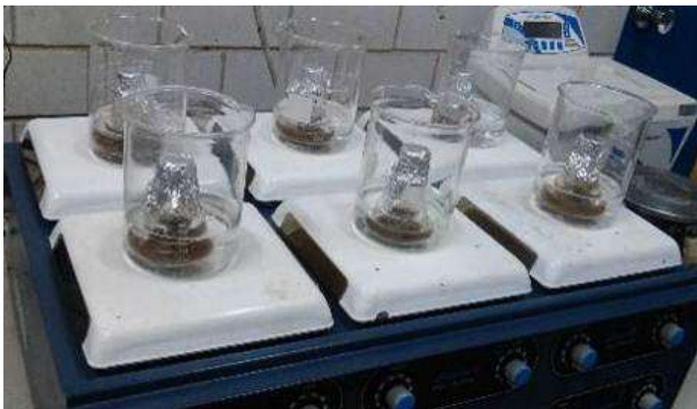
Figura 21. Hidrólisis enzimática de las muestras usando una relación 2:100 y 5:100, empleando un volumen de 150 \mu L de células de Aspergillus sp
