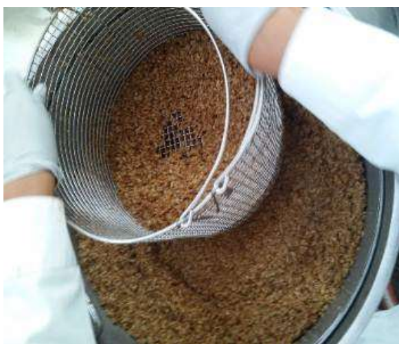
Figura 18. Filtrado del mosto (Planta piloto de Ingeniería Química, FQ-UNAM)
