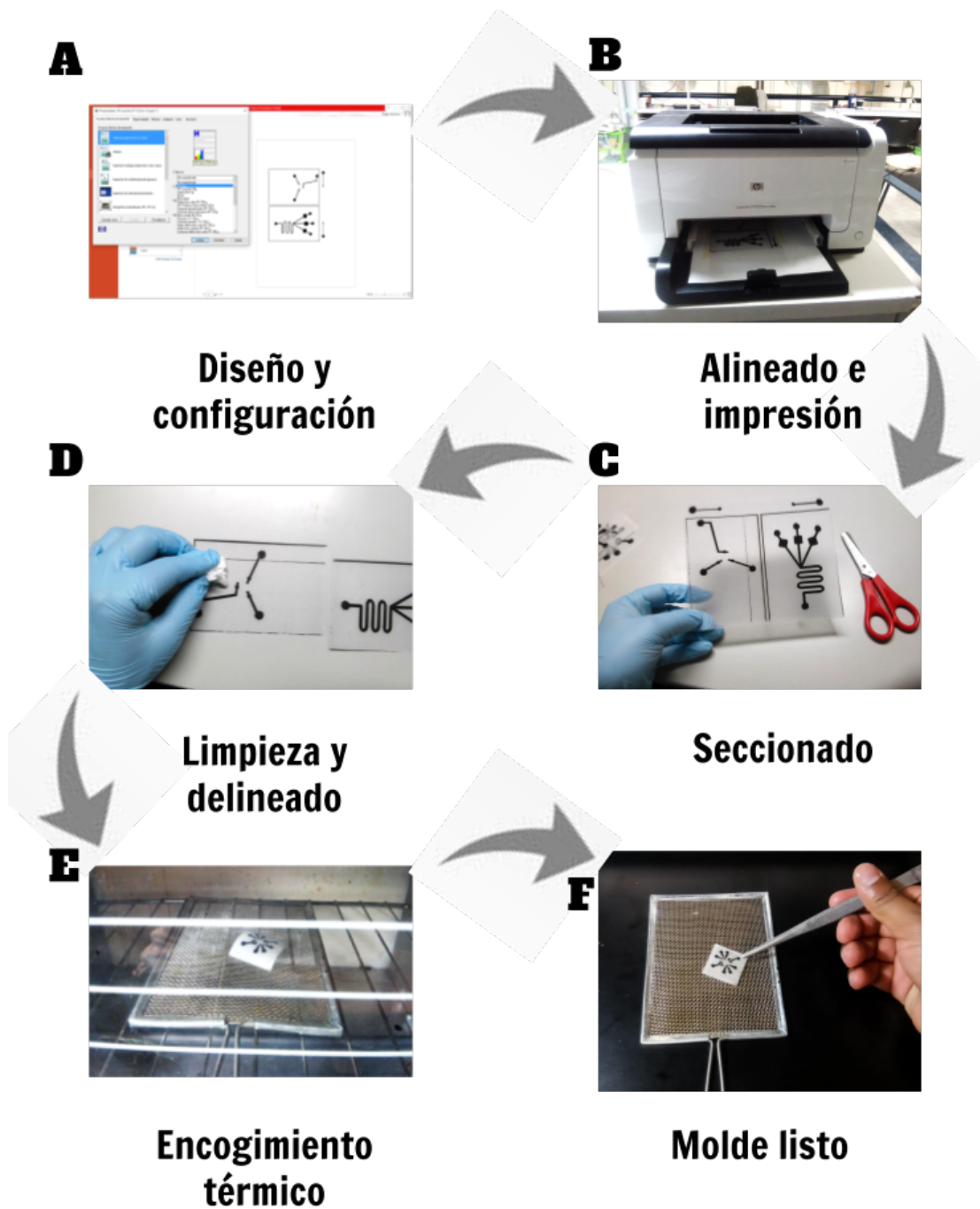
Figura 4-5: Proceso de fabricación de moldes con Shrinky Dinks.
