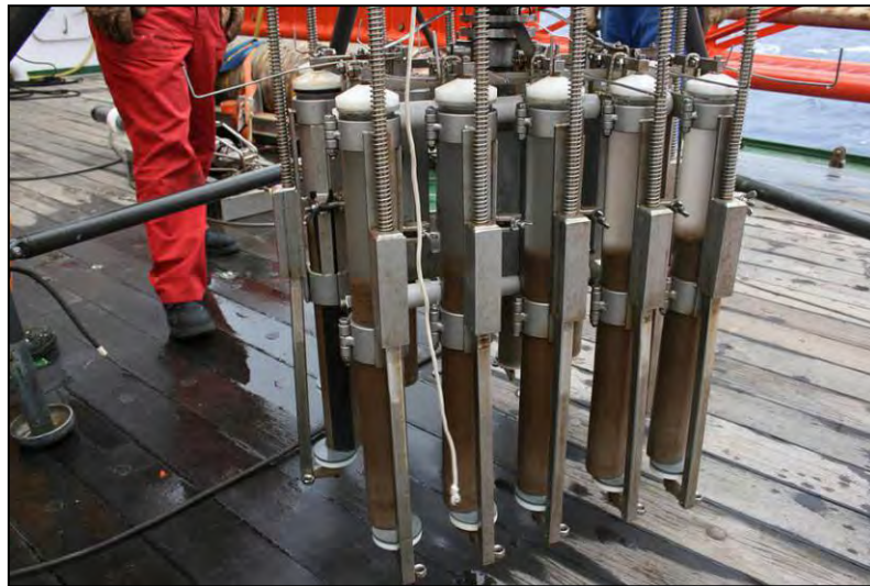
Figura 2 Tubos de multicorer 2 con muestra de sedimentos.
