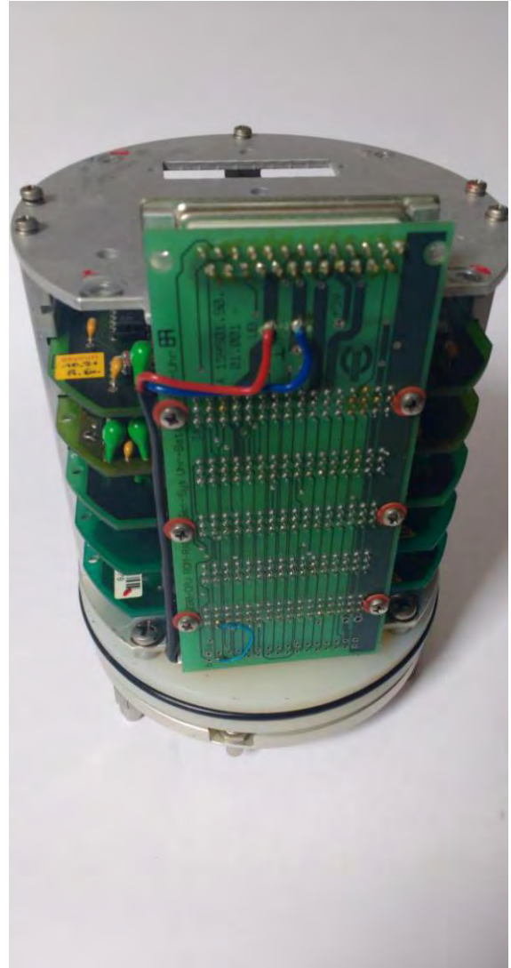
Imagen 4 - Circuito de control original, vista anterior.
