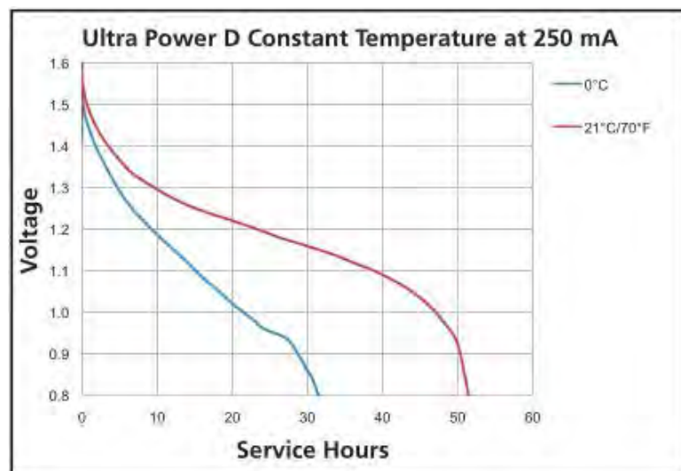
Figura 64 - Gráfica de descarga Duracell a 250mA, a 0°C y a 21°C.
