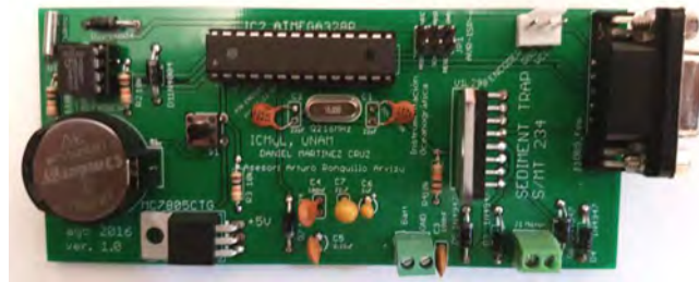
Figura 85 - PCB con todos los componentes soldados.
