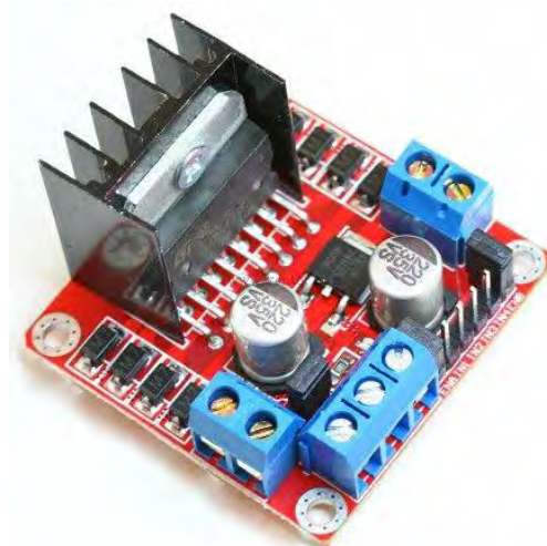
Figura 44 - Circuito L298N con disipador de calor.
