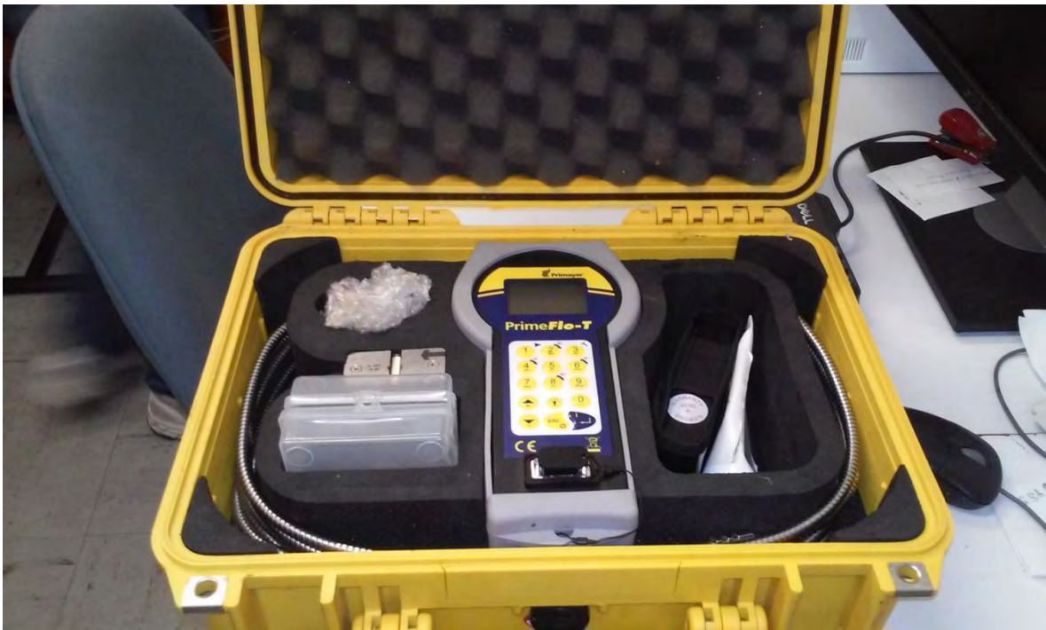
Imagen 6. Caudalímetro PrimeFlo-T Primayer, por Arturo Méndez
