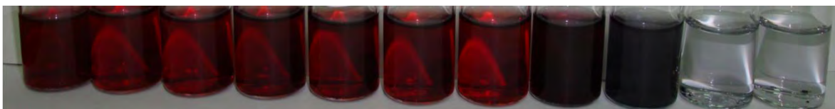
Figura 4.11 Modificación de coloración de las NPs coloidales de oro por efecto del cambio de concentración de agente estabilizante \text{Na}_3\text{Cit} .
