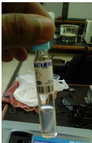
Figura 32.- Vial Nitrito TNTplus, bajo rango, antes y después de ser usado. En las imágenes se puede apreciar el color opaco que se genera en el frasco tras la prueba. Fotografías de realización propia.
