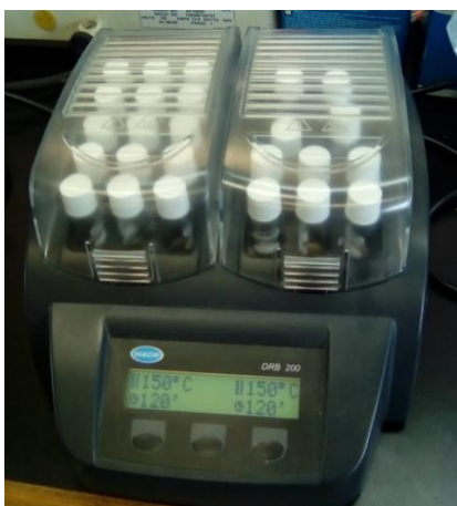
Figura 28.- Reactor calentando los tubos de reactivo para DBO. Fotografía de elaboración propia.
