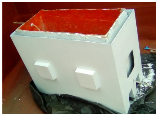
Imagen 4.- Módulos de maceta-humedal ya terminados. Fotografía de elaboración propia.
