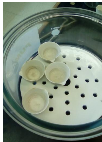
Figura 52.- Cápsulas de porcelana tras el proceso de calcinado, su interior se aprecia de tono gris. Fotografía de elaboración propia.
