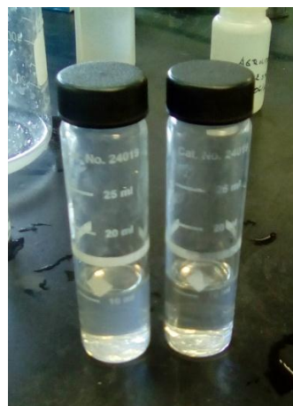
Figura 45.- Comparativa visual de los colores de las muestras de agua antes y después de la prueba para determinación de Sulfatos.
