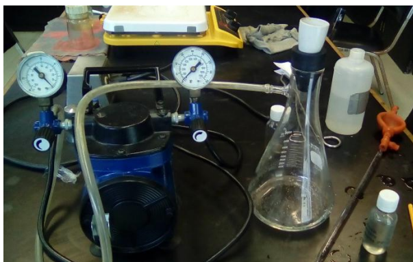
Figura 57.- Instalación completa de la bomba de vacío, el matraz Kitasato y el adaptador de hule. Fotografía propia.
