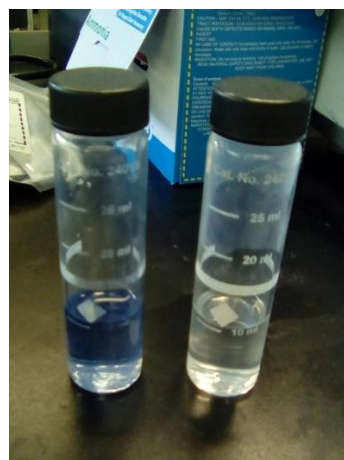
Figura 41.- Comparativa visual de los colores del agua muestreada antes y después de aplicado el reactivo fosfato PhosVer 3. Fotografía de realización propia.
