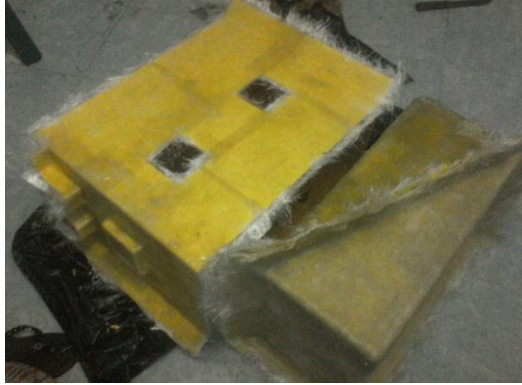
Imagen 3.- Moldes secundario de fibra de vidrio en proceso de secado. Fotografía de elaboración propia.
