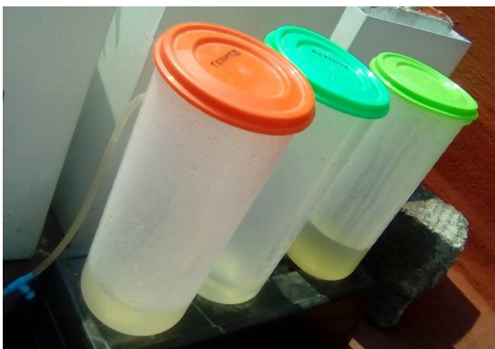
Figura 70.- Botes de salida para agua tratada en medio de la prueba de velocidad. Fotografía de elaboración propia.
