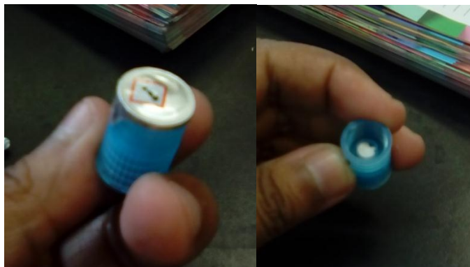
Figura 33.- Tapa del vial Nitrito TNTplus, bajo rango, con su doble compartimiento y su contenido. Fotografías de realización propia.
