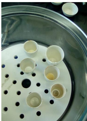
Figura 60.- Imagen de los crisoles tras salir de la mufla eléctrica; los SST se tornaron en color gris por la calcinación. Fotografía de realización propia.
