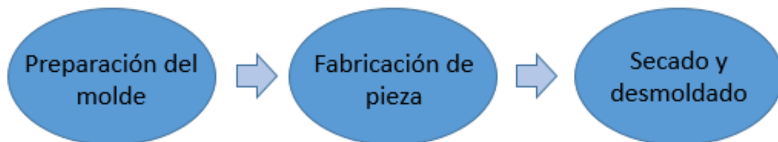
Imagen 2.- Fases que conforman el proceso de creación de las piezas en fibra de vidrio. Esquema de elaboración propia.
