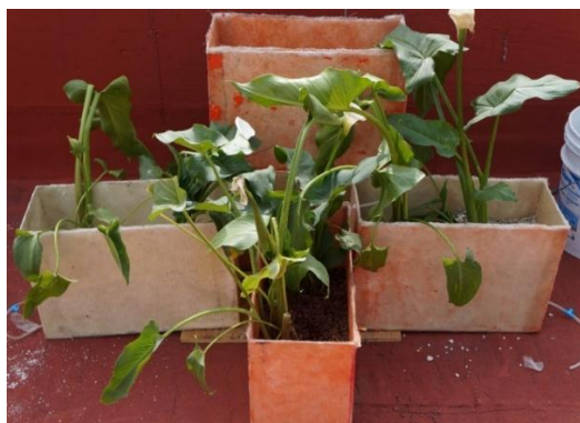
Figura 20.- Resultado final de la primera fase de instalación de los módulos de humedales artificiales. Fotografía de realización propia.
