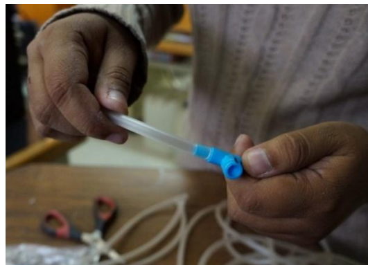
Figura 18.- Mangueras y válvulas empleadas en la instalación del prototipo. Fotografía de realización propia.
