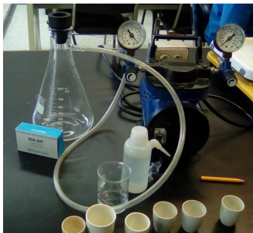
Figura 53.- Materiales y Equipo utilizado en la prueba con microfibras filtradoras. Fotografía propia.
