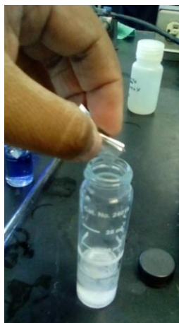
Figura 40.- Vertido del reactivo en polvo dentro de la almohadilla fosfato PhosVer 3. Fotografía de realización propia.
