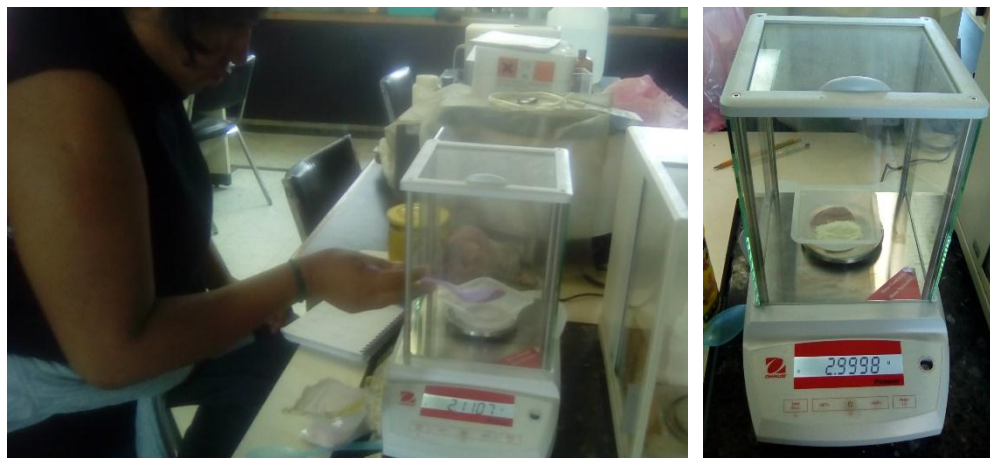
Figura 22.- Pesado de ingredientes para la elaboración de agua gris artificial. Fotografías de realización propia.
