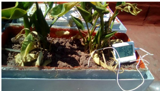
Figura 73.- Lectura con el termómetro en la orilla de uno de los módulos de humedal artificial. Fotografía de elaboración propia.
