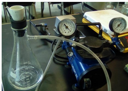
Figura 54.- Filtración de agua destilada para el lavado del filtro. Fotografía propia.
