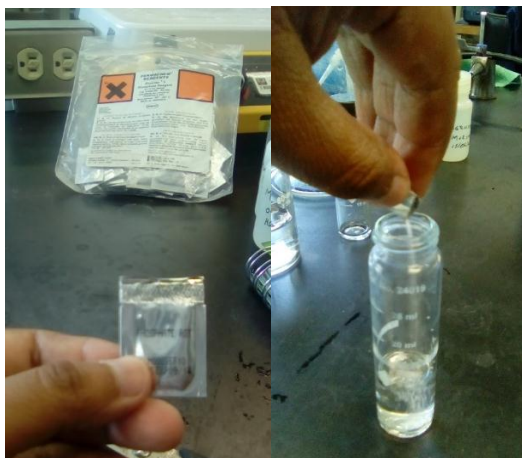
Figura 44.- Almohadilla SulfaVer 4 con reactivo en polvo y su vertido en el interior del frasco con muestra de agua. Fotografía de realización propia.
