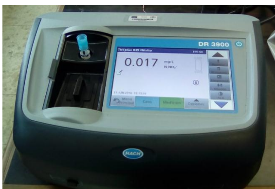
Figura 34.- Espectrofotómetro realizando las mediciones de los viales Nitrito TNTplus, bajo rango. Fotografía propia
