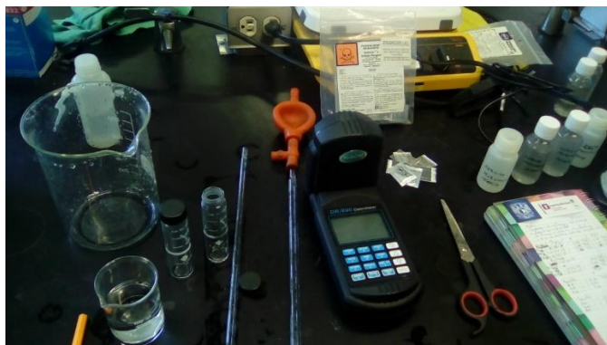
Figura 42.- Herramientas y materiales empleados en la prueba de determinación de Sulfatos totales. Fotografía de realización propia.
