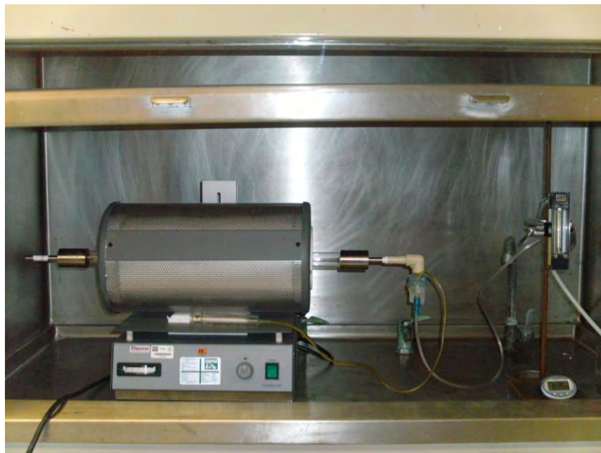
Figura 2.1. Sistema para síntesis de NTC
