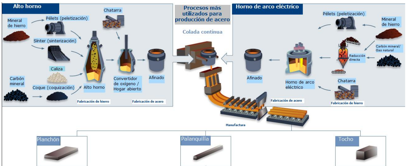
Ilustración 1.6 Procesos más utilizados para producción de acero. Traducción propia y modificación de WSA (2013)
