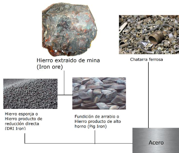
Descripción gráfica de paso de hierro a acero. Elaboración propia con imágenes de TSI (2016)
