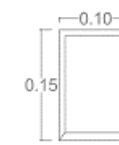
Perfil rectangular hecho a base de dos ángulos de lados desiguales soldados
