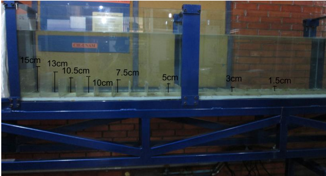
Figura 4.7: Fotografía de los obstáculos colocados para simular la capa límite atmosférica
