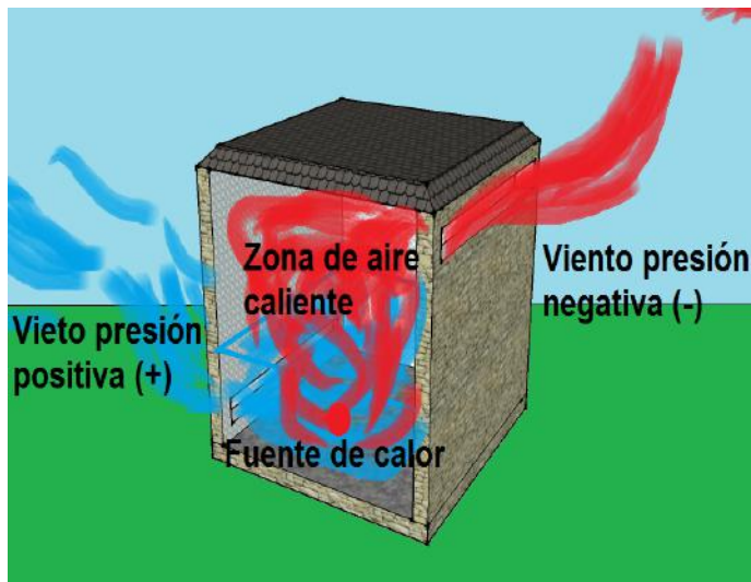
Figura 2.4: Representación del efecto de la flotación asistida por el viento. El viento va de un lugar de alta presión a uno de baja presión al mismo tiempo que las densidades del aire cálido y frío juegan su papel en la ventilación del recinto. La fuente de calor puede representar a las personas en la habitación o bien los electrodomésticos.
