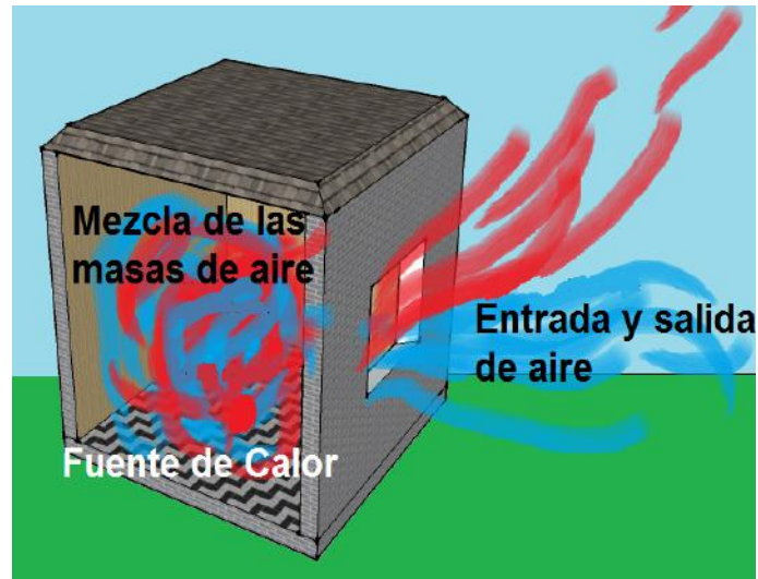
Figura 2.2: Esquema de la ventilación por mezclado. En este caso las masas de aire interactúan entre sí, no se forma interfase térmica.
