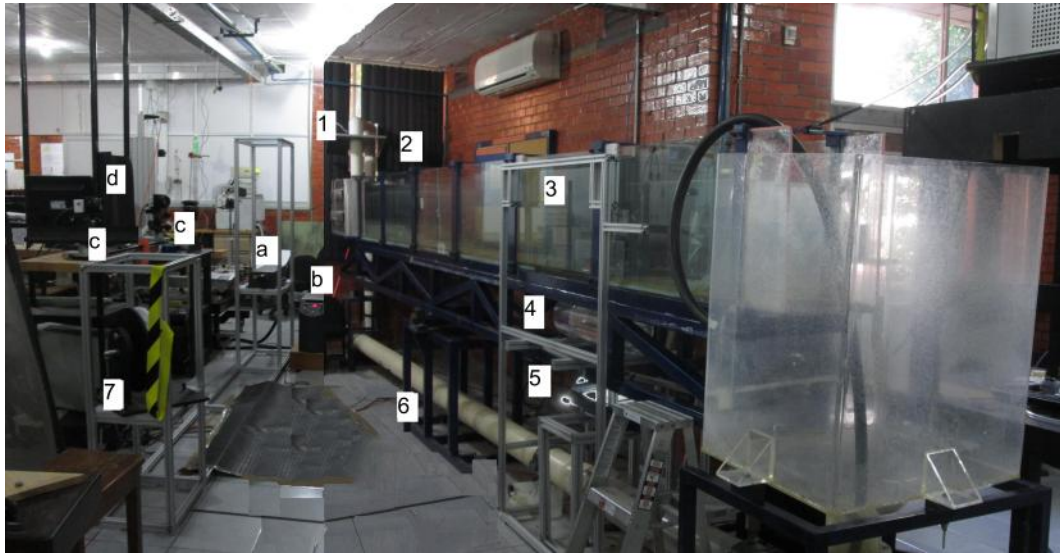
Figura 4.5: Fotografía del canal de agua y del sistema SPIV. 1) Entrada de agua, 2) Canal de agua, 3) Zona de estudio, 4) Lente cilíndrico, 5) Espejo plano rectangular inclinado, 6) Tubería de recirculación, 7) Espejo; a) Láser, b) Sistema de enfriamiento láser, c) Cámaras, d) Equipo de cómputo.
