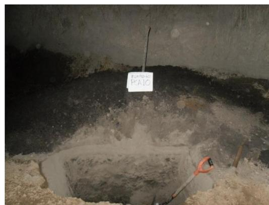
FIGURA 14.- PERFIL ESTRATIGRÁFICO DEL PCA-10
