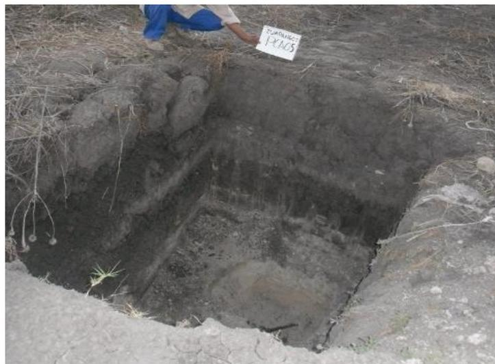
FIGURA 9.- PERFIL ESTRATIGRÁFICO DEL PCA-5
