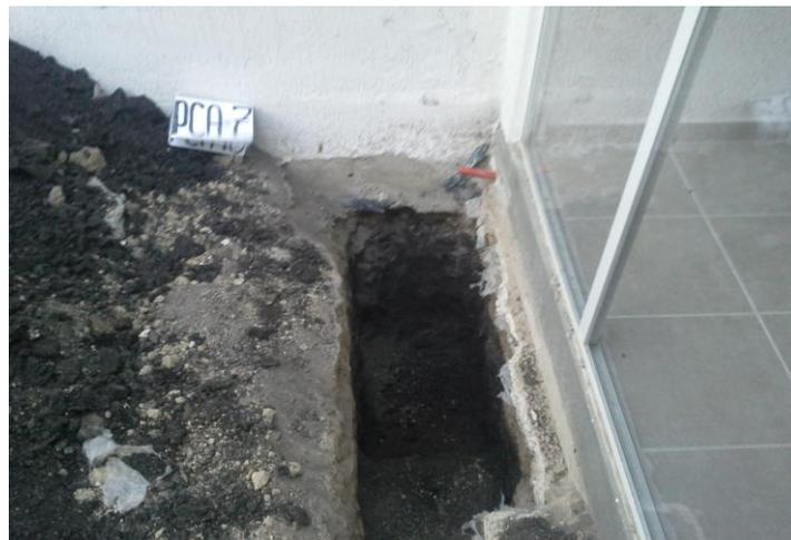
FIGURA 13.- PERFIL ESTRATIGRÁFICO DEL PCA-7
