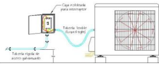
DETALLE UNIDAD EXTERIOR ACOMETIDA A LUZ
