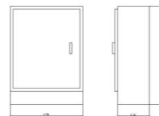
ARMARIO DE DISTRIBUCION TELMEX
