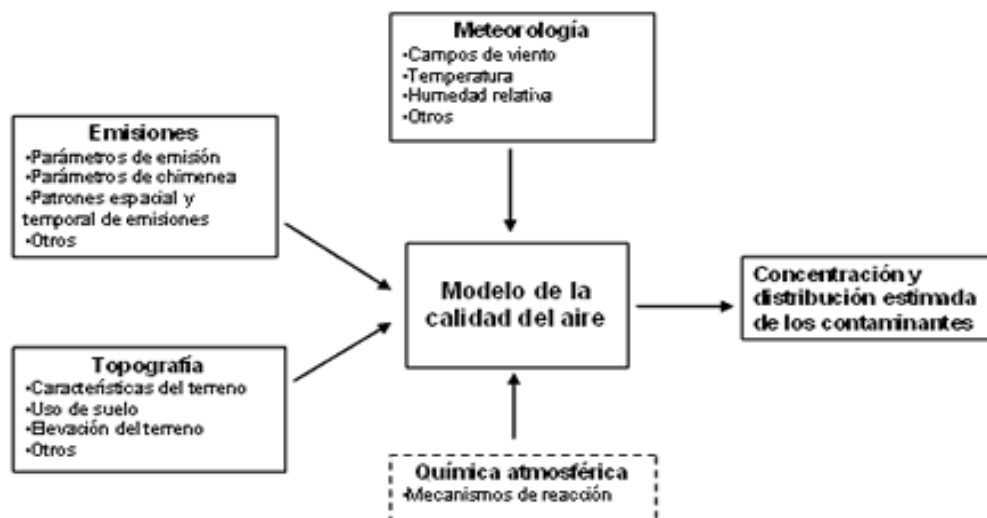
Figura 4.- Insumos de los sistemas de modelización que se necesitan para calcular la concentración y distribución estimada de los contaminantes atmosféricos, imagen tomada de (INE, 2006)
