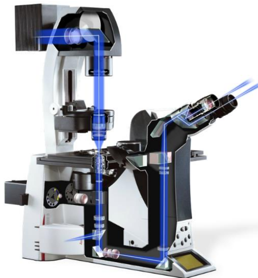
Figura 4. Trayectoria del haz de luz transmitida. La luz es producida por una lámpara simple enfocada a la muestra por el condensador. Posteriormente pasa a través de la muestra, la absorción de luz y otros efectos producen la imagen que se observa.[11]
