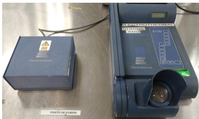
Fotografía 6. Equipo de índice de punto de fusión Electrothermal (fotografía de la autora)
