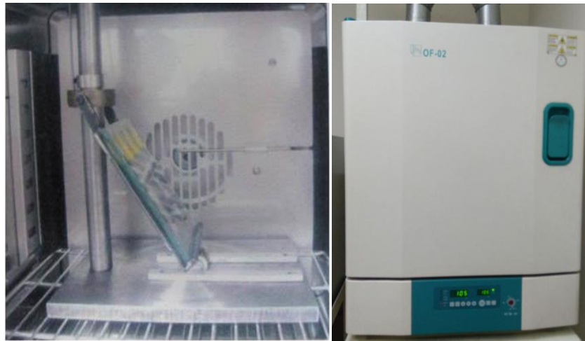
Fotografía 5. Dispositivo para fluidez de resina y horno de calentamiento OF-02 (fotografía de la autora)
