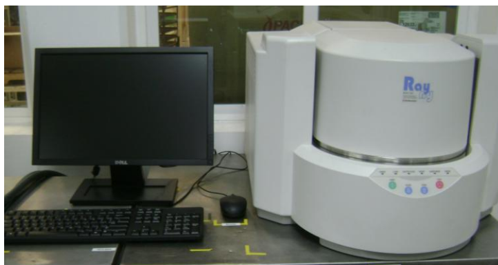
Fotografía 7. Espectrómetro de fluorescencia de rayos X Shimadzu (fotografía de la autora)
