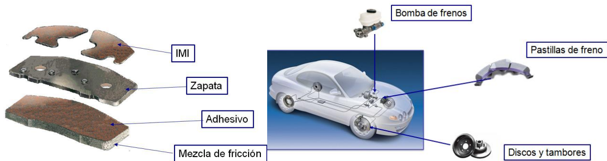
Figura 4. Partes de las Balatas y su ensamble (Federal Mogul, curso de inducción, 2015)
