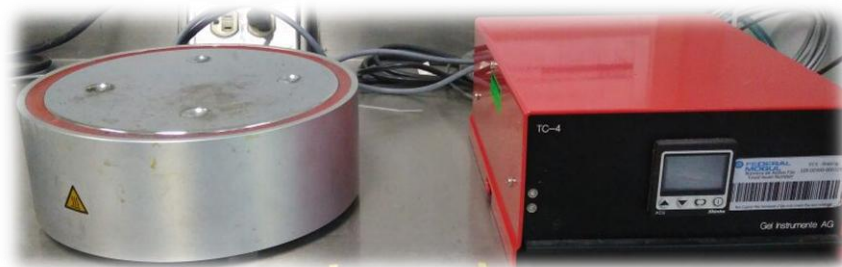
Fotografía 4. Platina de calentamiento Gel Instrument AG -TC-4 (fotografía de la autora)
