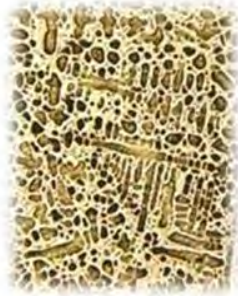
Figura 4.2 Micrografía de bronce estándar a 50x
