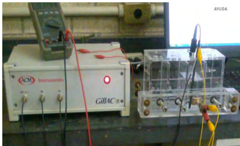
Figura 3.4 Montaje experimental utilizado en los ensayos electroquímicos.
