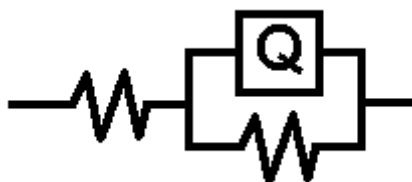
Figura 4.14. Circuito eléctrico utilizado para hacer ajuste con el diagrama de impedancia y sacar datos para calcular la C_{DL} .
