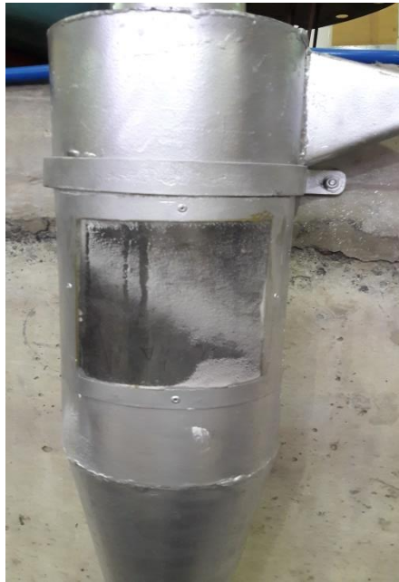
Figura 11. Separador ciclónico con partículas adheridas de la malla 270
