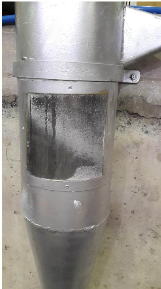
Figura 12. Separador ciclónico con partículas adheridas de maíz de malla 300
